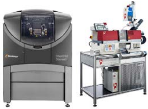
图 2：打印机结合微型注塑机，快速提供原材料的注塑件
