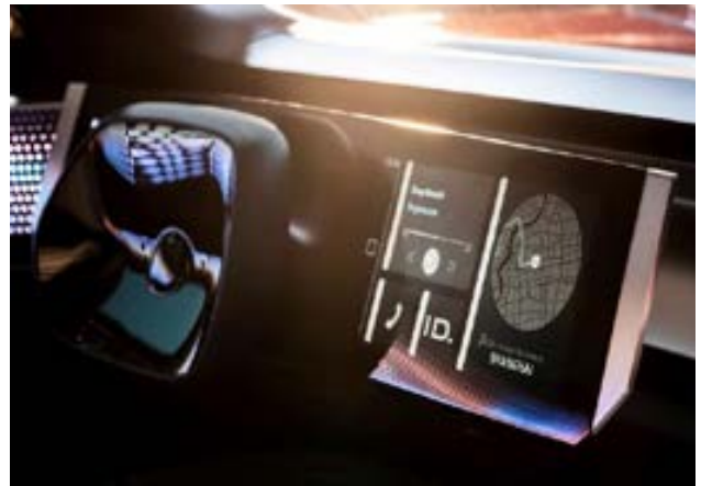
图 2：带有数字化控制元件的方向盘被集成在一个大型「数字化座舱」中，取代了传统的仪表盘
