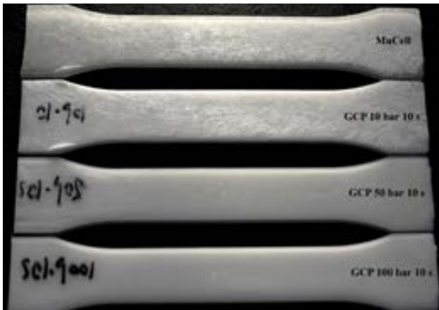
图 1：反压低于 50 Bar 时，产品表面会呈现粗糙不光滑；反之，若高于 50 Bar，则产品表面显得极为光滑
