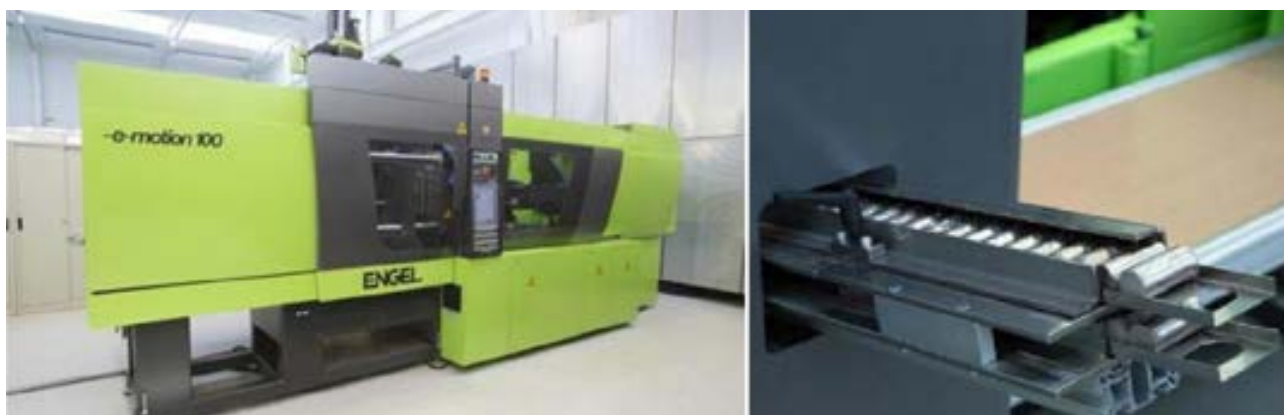
图 4：左图：最先进的 LQMT 压铸机与传统塑料注塑成型机外型类似，主要差异在于真空熔体腔（熔汤槽）；图右：LQMT 的定量注射要熔掉的一整个材料锭形状
