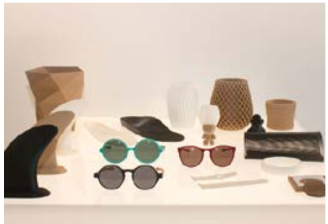
图 4：图为透过 PAM 颗粒打印机产出的成品，该机器除可生产样品外，也适用于生产功能性原型
