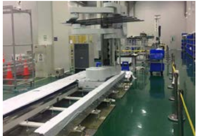
图 2：透过创新的优化设计、高速振动抑制技术与专用材质的开发，使机器人得以顺利搬运纤薄的 OLED 器件
