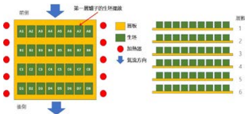
图 1：简单表示产品的摆放与设备（炉体的相对关系，图左仅显示一层，实际有 6 层）
