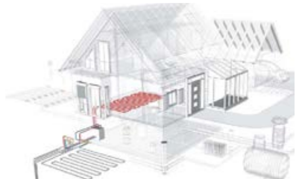
图 3 : Raugeo 地面回路热交换系统。每个钻孔有两个 U 形弯头，能量提取量高达 20%
