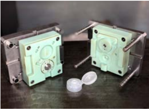
图 1：绿色部份为透过 PolyJet 3D 打印技术快速打印而成的耐高温塑胶模仁
