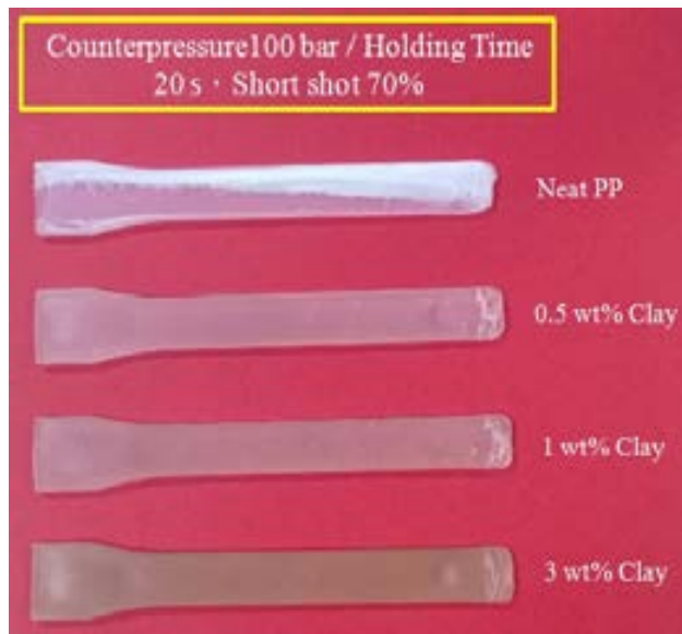
图 4：从加入奈米蒙脱土有助于提升材料阻气性，图中可观测到，加入蒙脱土后，便没有气泡进入产品的情形发生
