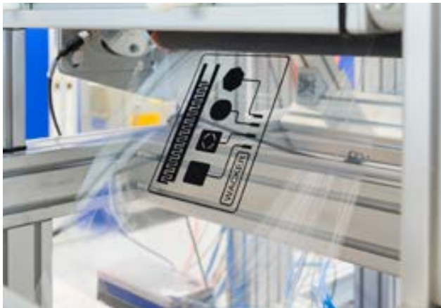
图 3：由多层涂有导电材料的超薄有机硅精密薄膜组成，可用作运动执行器或测量机械形变的传感器
