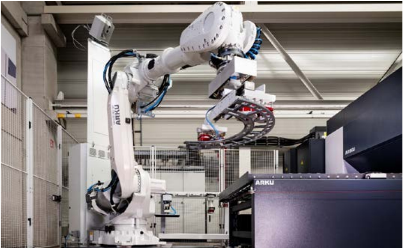
图 1：能抓取、会观察的阿库视觉机器人加速了矫平去毛刺设备的上下料流程
