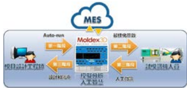
图 2：导入 CAE 模流分析 Moldex3D，搭配无缝整合模具 CAD、制造 CAM，与生产现场累积之相关参数，形成大量数据库加以分类归纳，以供设计、制造、生产人员参考
