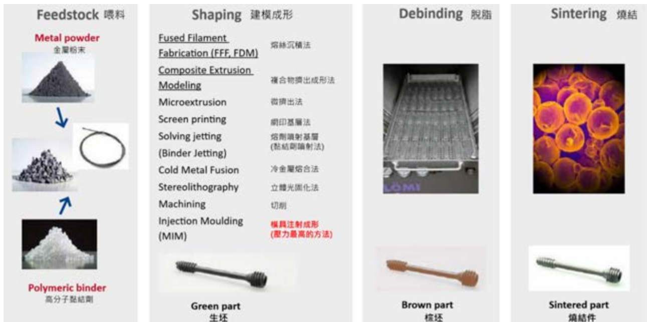
图 5：以 MIM 喂料加工方案——AM 的建模成型方法变得非常灵活
