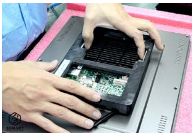
图 1：左为研华科技最新研发的互动式曲面萤幕；右为「研华科技」使用 3D 打印治具在产线实际的应用情形，资深工程师 林宏宇谈到：「导入 3D 打印机让治具的设计开发能与产线透过协作的方式快速并直接地满足其使用需求。」
