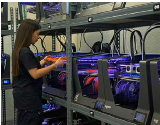
图 7：BCN3D Sigma D25 3D 打印机，能同时 3D 打印两个完全相同或左右对称的物体
