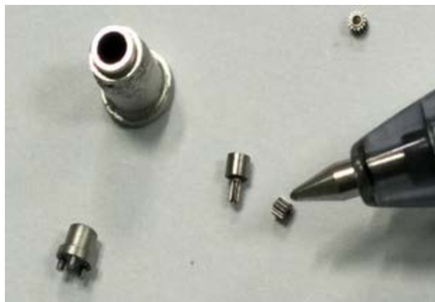
图 6：（左）由 FFF 用 Ti-6Al-4V 粉末所打印的演示齿轮组合（德国埃默里奥利奥化学有限公司开发的粘合剂系统，在元素 22 公司内进行脱脂和烧结）；（右）使用传统粉末注射成形齿轮的限制在于零件尺寸过小时，模具对于螺旋与协齿轮无法制做，只能制作正齿轮（右图由 Dr. Q 拍摄）
