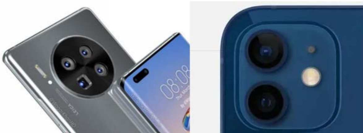
图 2：智能手机的背面相机镜头保护盖仍使用 MIM 零件。坚固、亲合人体和 EMC 功能要求让设计师选择 MIM 零件。（华为喜欢用 MIM 316L；苹果则喜欢 ASTM F75 作为镜头保护罩）
