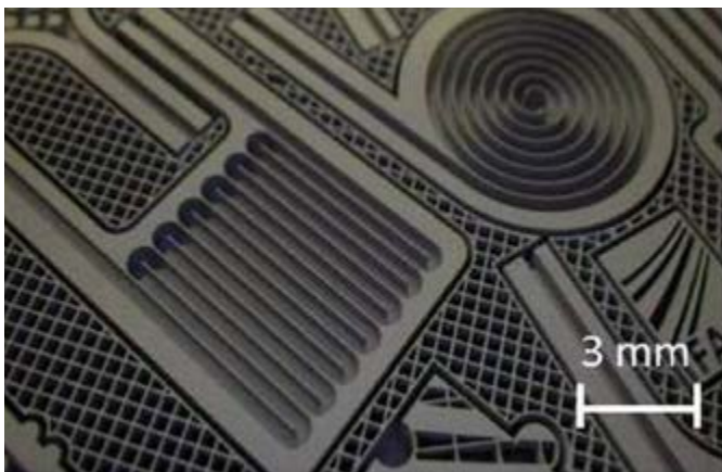
图 7：左是由钛喂料丝打印制成的演示零件（德国德累斯顿弗法 IFAM）；右则是由钛光固化打印制成的演示零件（由奥地利 Incus GmbH 制造，在德国元素 22 GmbH 上烧结）
