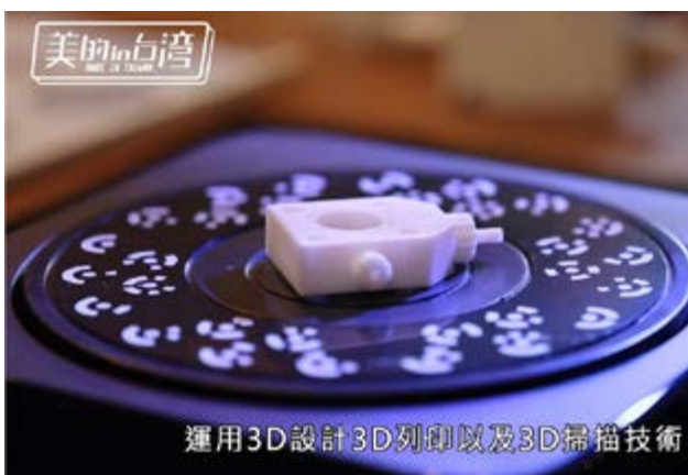
图 2：GiT 港擎科技产品设计经理，使用 3D 扫描器及 360 度自动旋转盘，建立一个零件电子档平均只要 5 分钟
