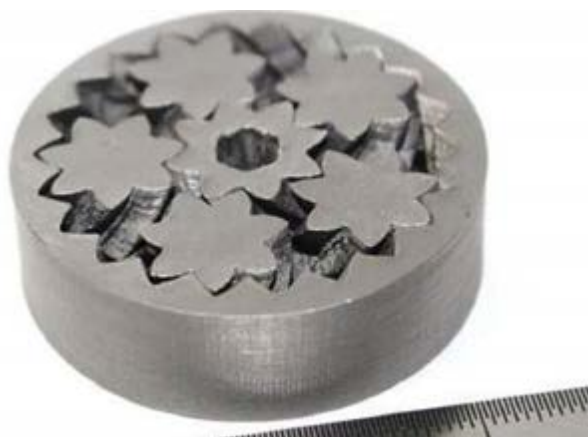
图 6：（左）由 FFF 用 Ti-6Al-4V 粉末所打印的演示齿轮组合（德国埃默里奥利奥化学有限公司开发的粘合剂系统，在元素 22 公司内进行脱脂和烧结）；（右）使用传统粉末注射成形齿轮的限制在于零件尺寸过小时，模具对于螺旋与协齿轮无法制做，只能制作正齿轮（右图由 Dr. Q 拍摄）
