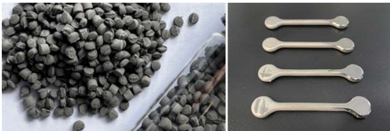
图 4：考虑钛与钛合金的操作安全，MIM Extra ® POM 基喂料产品是业界可以如方便面打开即用的安全喂料。（左）MIM Extra ® TC4 POM 基喂料；（右）经过注射成型并脱脂烧结后，在右端抛光的狗骨头拉伸试棒
