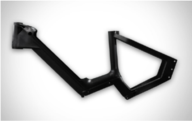
圖 1：該款全塑膠骨架不僅減輕 20% 重量、提高 70% 剛性，同時也減少了 50% 的碳足跡
