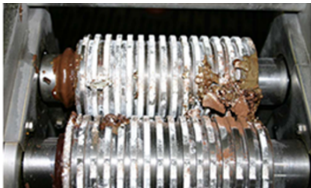
圖 4：乾冰清洗樹脂材料
