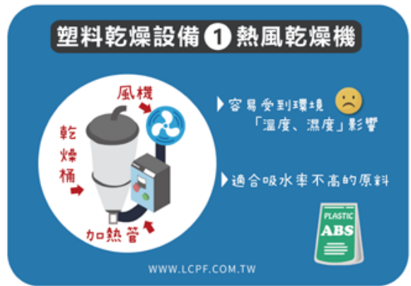
圖 4：熱風乾燥機的簡易說明
