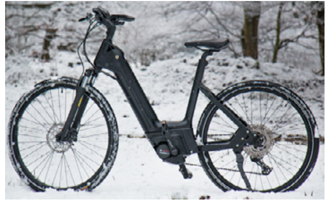
圖 2：為使自行車更加輕巧靈活，V-Frame 的全塑骨架方案取消了頂杆設計
