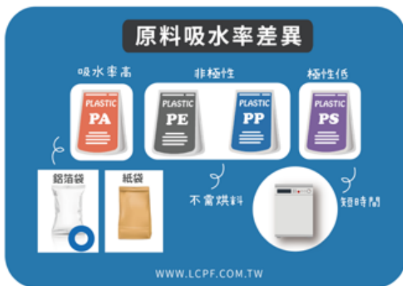
圖 3：常見高吸濕與不吸濕的原料種類
