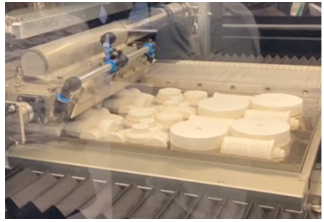
圖 4：噴射陶瓷 3D 印表機列印倉
