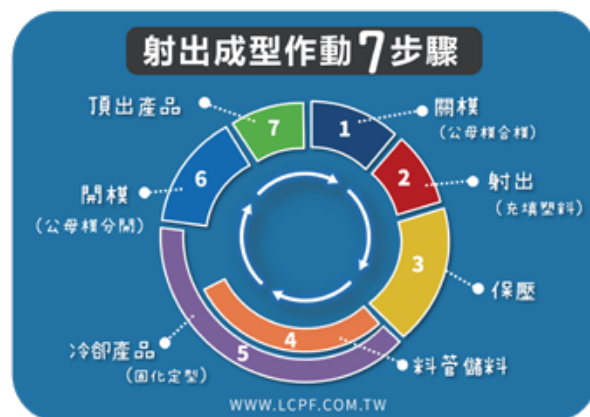
圖 6：射出成型作動的 7 個循環步驟
