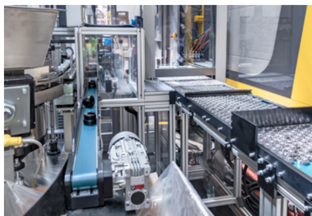
圖 5：viper 機械手同時處理插入件和完成件。滾珠軸承通過傳送帶輸送，完成件通過傳送帶送出（圖片來源：ENGEL）
