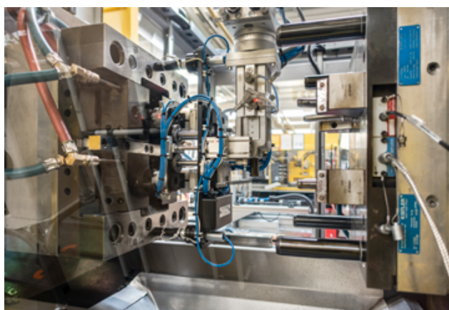
圖 4：由於沒有拉桿干擾，viper 機械手的夾具可直接從側面伸入打開的模具。（圖片來源：ENGEL）
