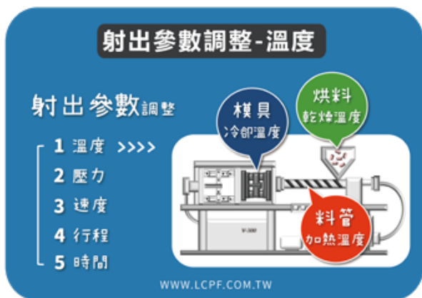
圖 5：射出參數調整中的三種溫度設定
