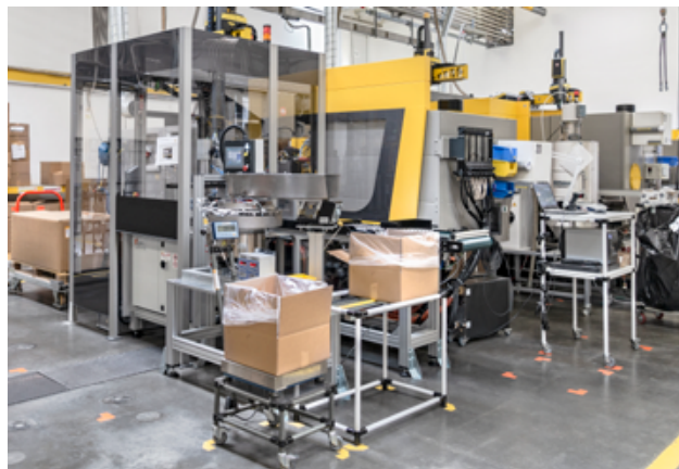
圖 2：對於新的生產過程，Interroll 投資建設了一個集成生產單元，包括一臺 ENGEL victory 120 射出機和一臺 ENGEL viper 12 線性機械手（圖片來源：ENGEL）
