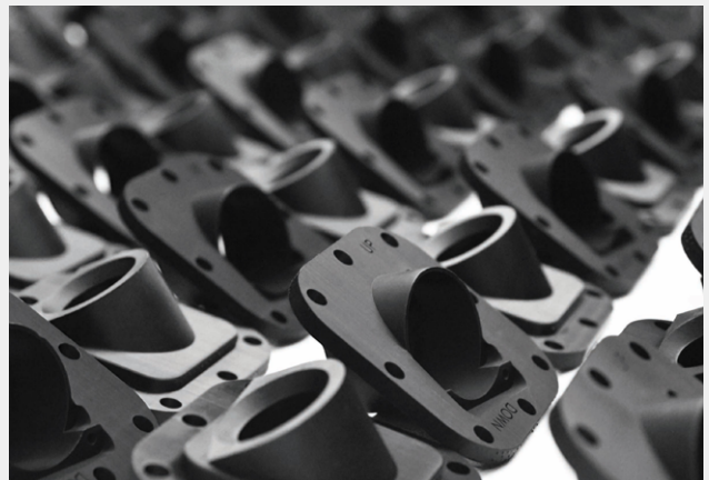
圖 5：Origin One 選用自家系統製作系統 8 小時內 1 次列印 40 個零件
