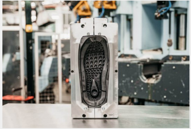
圖 3：ECCO 案例以 Henkel Loctite 材料來訂製鞋楦模具
