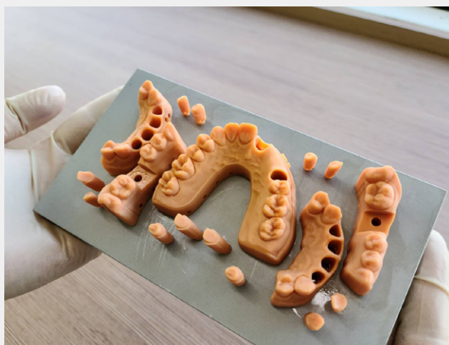
圖 1：MiiCraft Alpha 的高剛性結構有助於精準列印齒科工作模型
