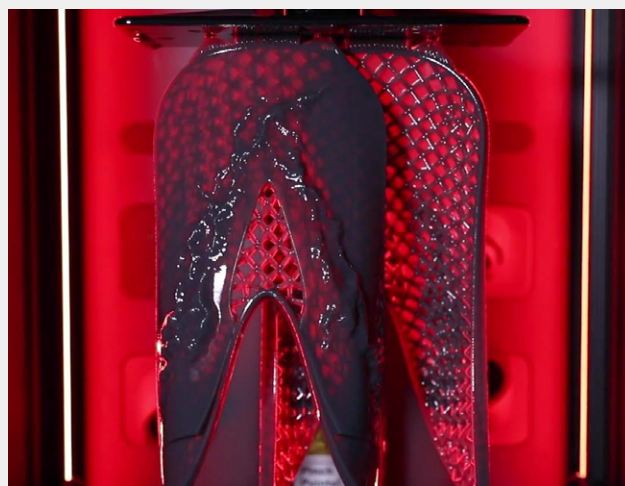
圖 7：運用 Origin One 和 Henkel Loctite 合作完成可調節滑雪背板（抗衝擊強度、耐力）
