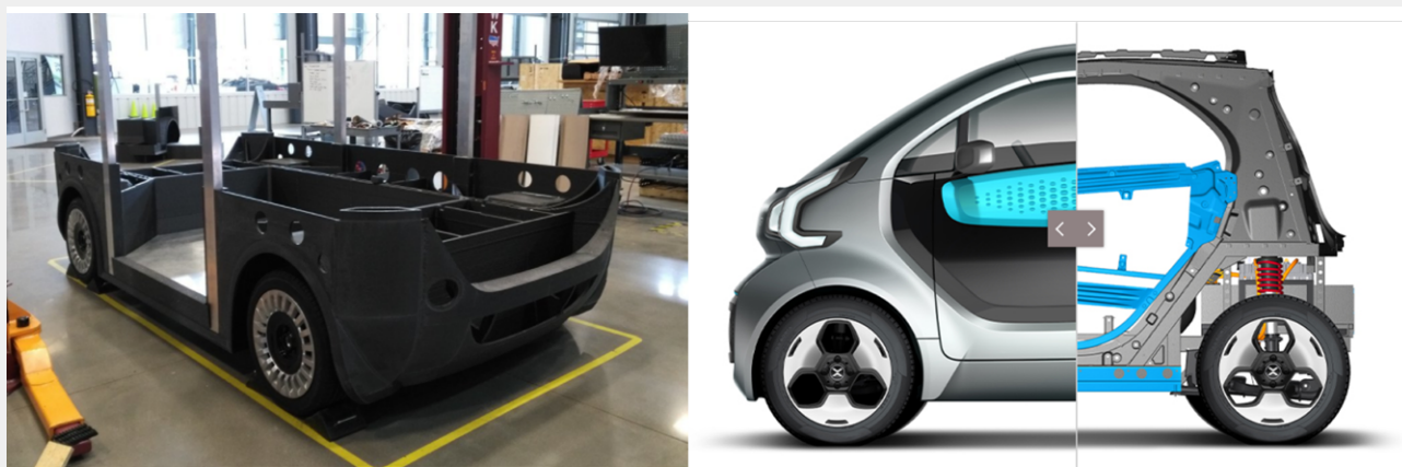
圖 1：Local Motor 展示 3D 列印 Olli 下半車身（左）、XEV 3D 列印 LSEV 低速電動車示意圖（右） [4,5]
