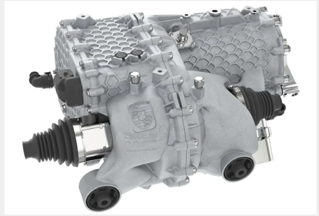
圖 2：勞斯萊斯公司展示汽車 3D 列印結構（左）、保時捷利用 3D 列印製造驅動器外殼（右） [4,6]
