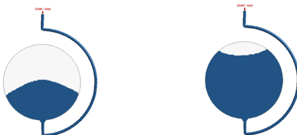
圖 3：以新的 GNF-X 黏度模型模擬射出成型 PC 圓盤
