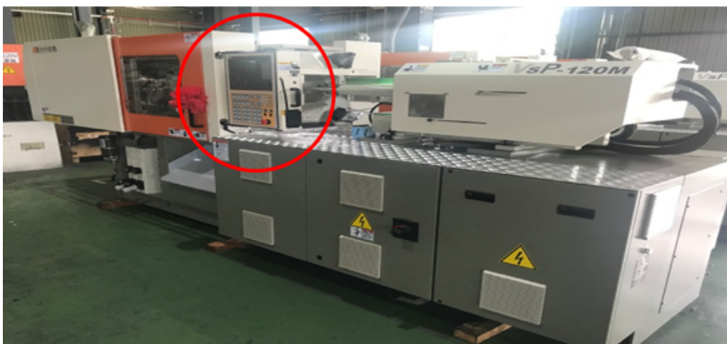
圖 5：控制器為射出成型機的整合輸出單元，合適的控制器應該具有高精度控制性、反應速度快、監控功能齊全、操作簡單方便且擴充性佳等特點，讓射出設備擁有良好的生產穩定度
