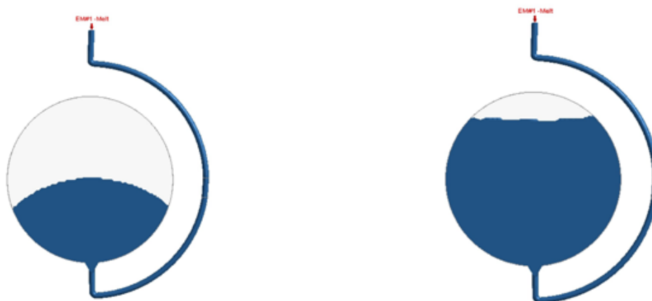
圖 2：以 GNF 黏度模型模擬射出成型 PC 圓盤
