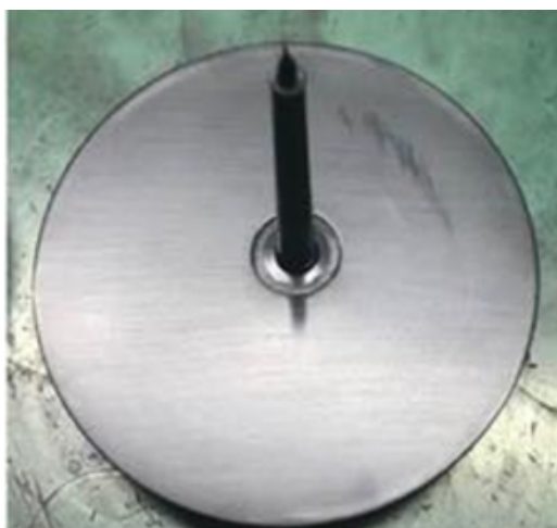
圖 12：設計變更塑膠產品表面應力痕
