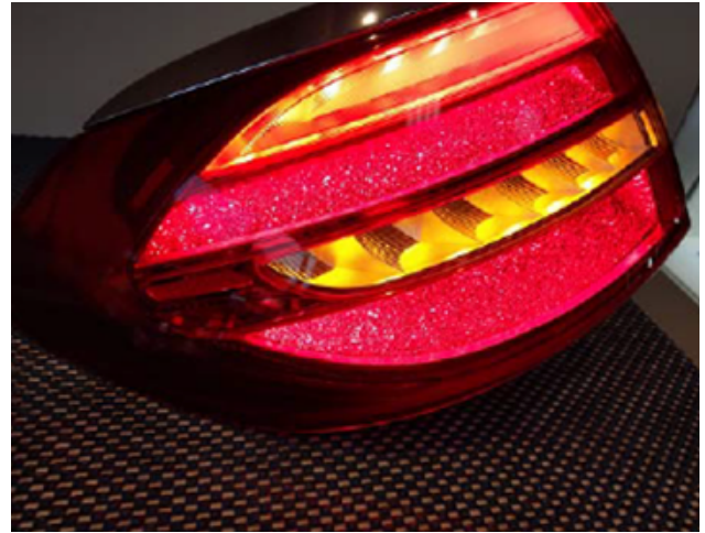
圖 3：車燈外殼成品——後車燈樣品，在剎車燈、方向燈與倒車燈等不同位置具有不同雷射紋理設計
