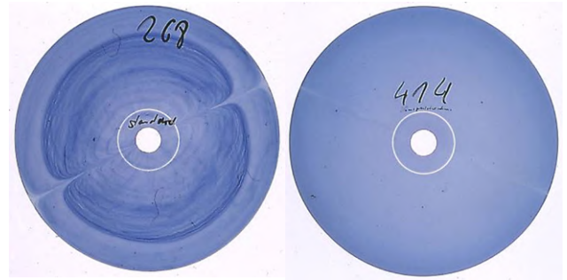
圖 4：標準螺桿 (左) 與 HPS-AT 螺桿 (右) 混合效果對比
