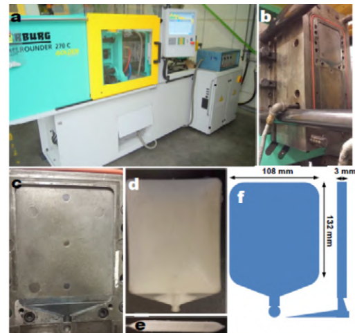
圖 7：視覺化模具實際在射出機上的情形
