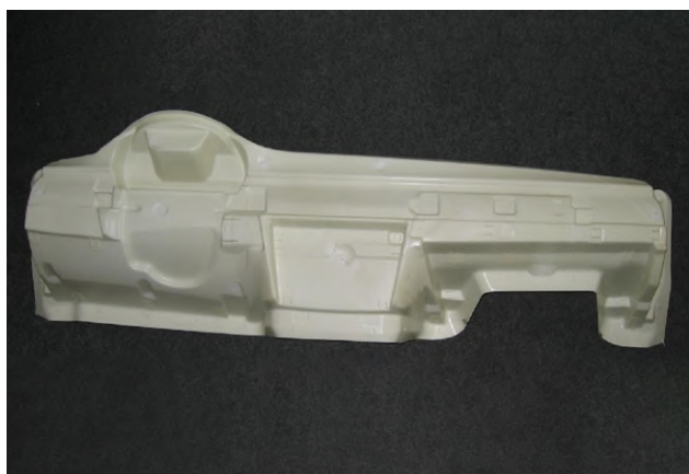
圖 1：長玻纖增強聚丙烯材料的發泡注射成型
