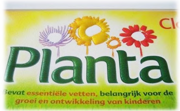
圖 8：在貼標上的 3D 凸字效果
