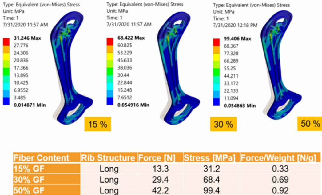
圖 9：設變後的結構分析結果（含纖量的影響）
