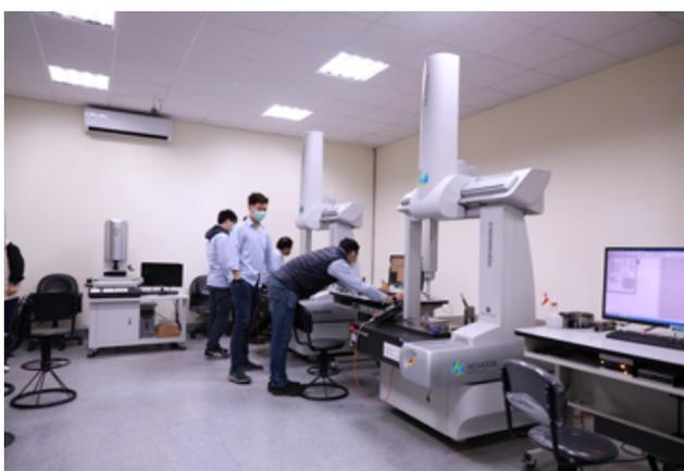
圖 3：完整的三次元和二次元量測驗證，確保尺寸公差無疑
