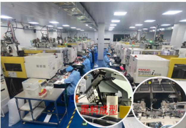
圖 3：塑膠鏡片以及黑料成型車間
