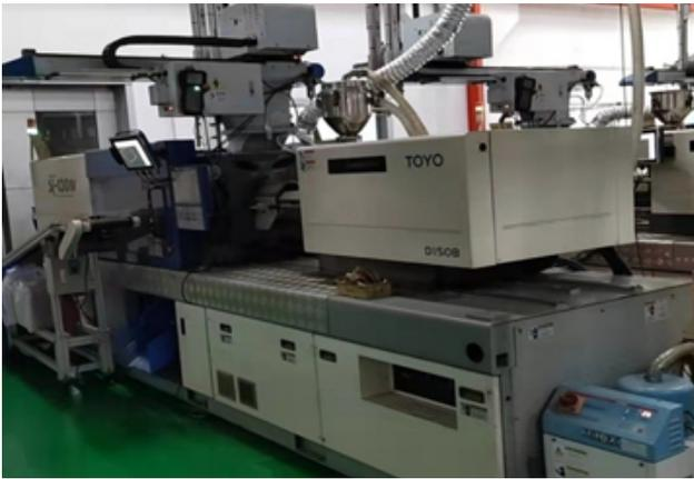
圖 1：全電式射出成型機
