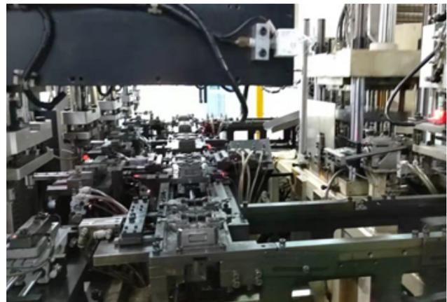
圖 4：STATOR 自動成型機
