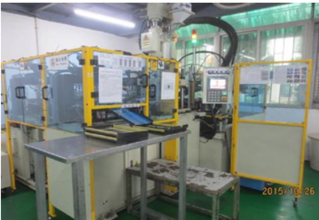
圖 3：STATOR 自動成型機
