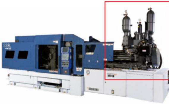
**圖 3：JSW XXX-MG 半固態成型機（紅色框主要是鎂合金射出的增壓系統，半固態的鎂金屬熔湯具有較高的黏度，必須利用此技術增壓射出）**
