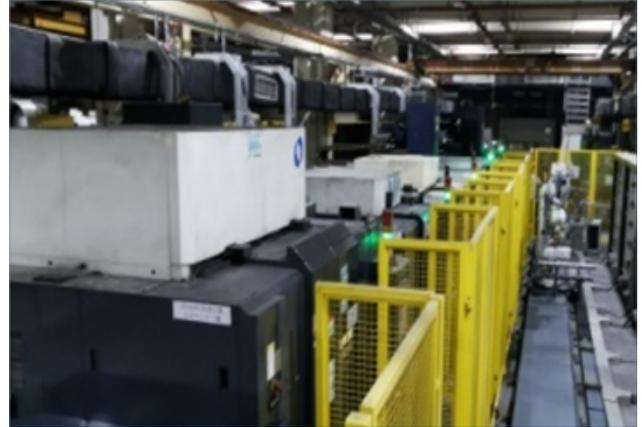
圖 3：放電加工自動化單元
