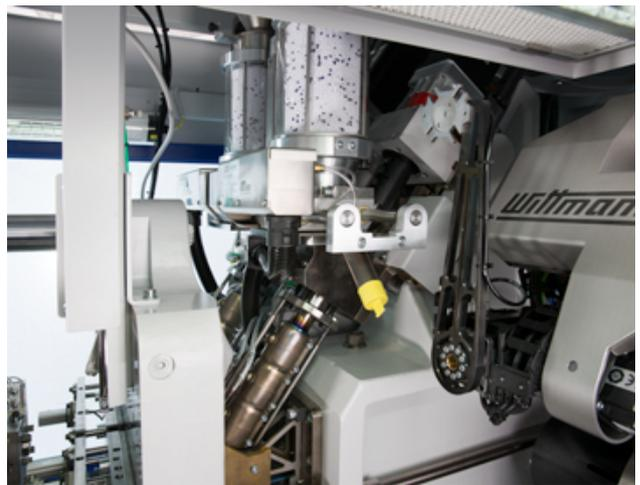
圖 4：塑化单元——微量的最佳控制
