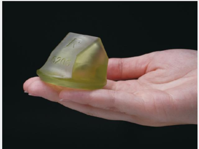
圖 6：Phrozen Nylon-Green Tough Resin 印製而成的零件通過檢驗測試
