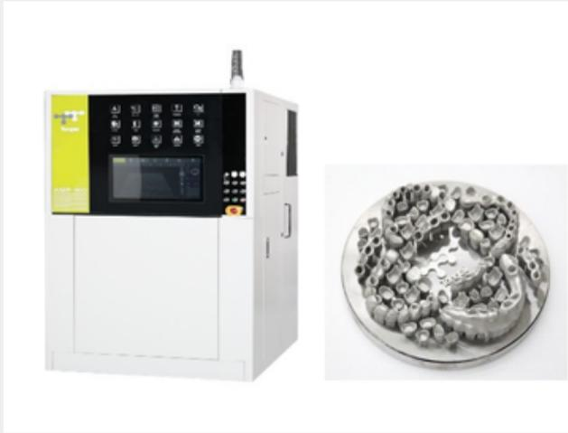
圖 4：選擇性雷射金屬燒熔設備及成品
