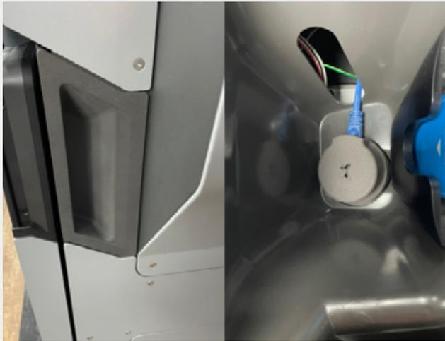
圖 5：每臺 Fuse1 上都有用 Fuse1 列印的成品零件
