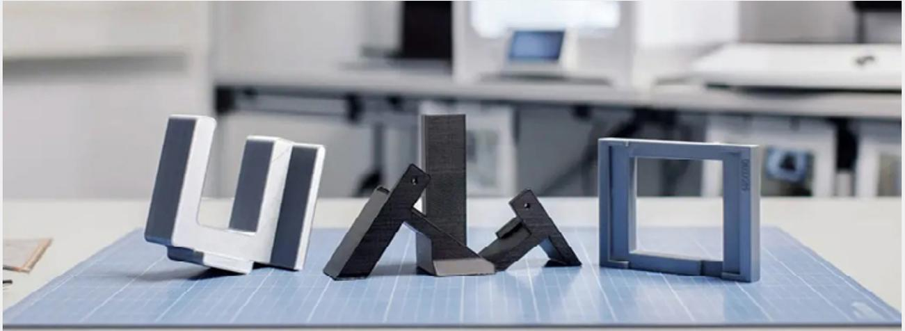
圖 2：蔡司團隊測量每臺機器上的角度，並使用 Ultimaker 3D 列印機製作對齊工具、光學轉接板固定工具；使用的 3D 列印線材選擇從各種塑料、尼龍、碳纖維到金屬，種類非常豐富
