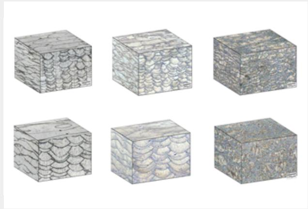
圖 4：鋁鎳銅成品進行均質化處理，金相微結構組織變化
