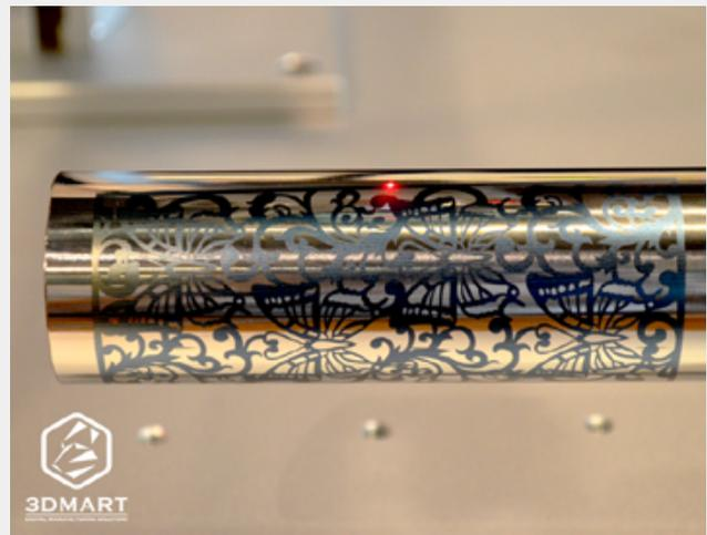
圖 5：使用不鏽鋼圓柱進行金屬雷射雕刻
