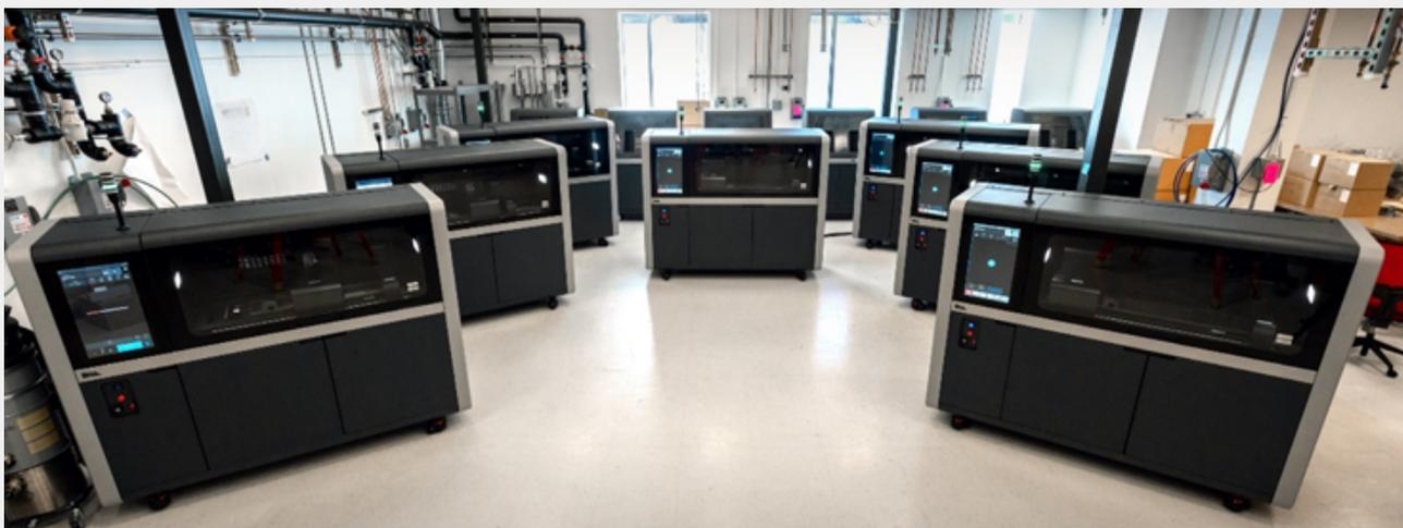
圖 4：大量生產金屬 3D 列印系統產線
