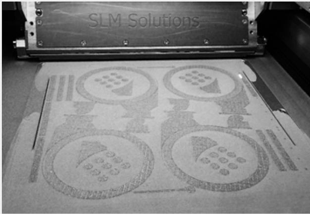
圖 3：鋁鎳銅粉末實際進行選擇性雷射燒熔列印驗證
