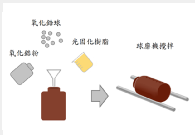
圖 3：氧化鋯漿料製備方法示意圖
