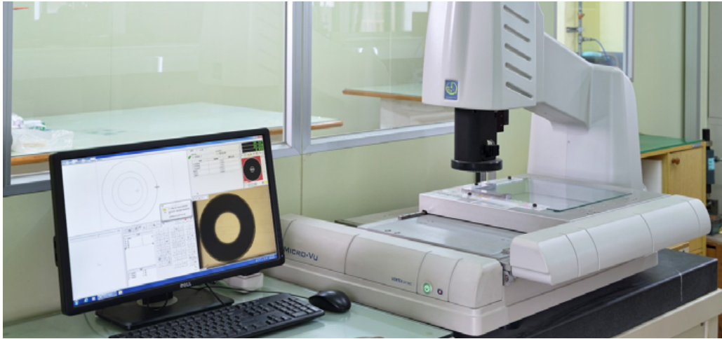
圖 1: 產品的檢驗也是評估協力廠商重要的一環，若射出廠能協助做尺寸及功能測試把關，那就能在交貨前就確保生產品質。 圖為 MICRO-VU 全自動投影檢測機，是全球佔有率最高的高精度影像自動量測儀
