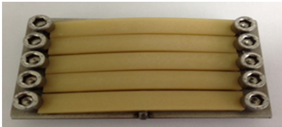
圖 4 : 置於氯化鈣和氯化鋅環境 200 小時後，AKROTEK® GF30 仍完好無損
