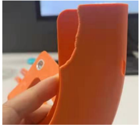
圖 1：金暘通過 CAE 模流分析，模擬 BG30EK 在護板中的射出情況，觀測到塑膠充填良好，但在產品末端存在困氣
