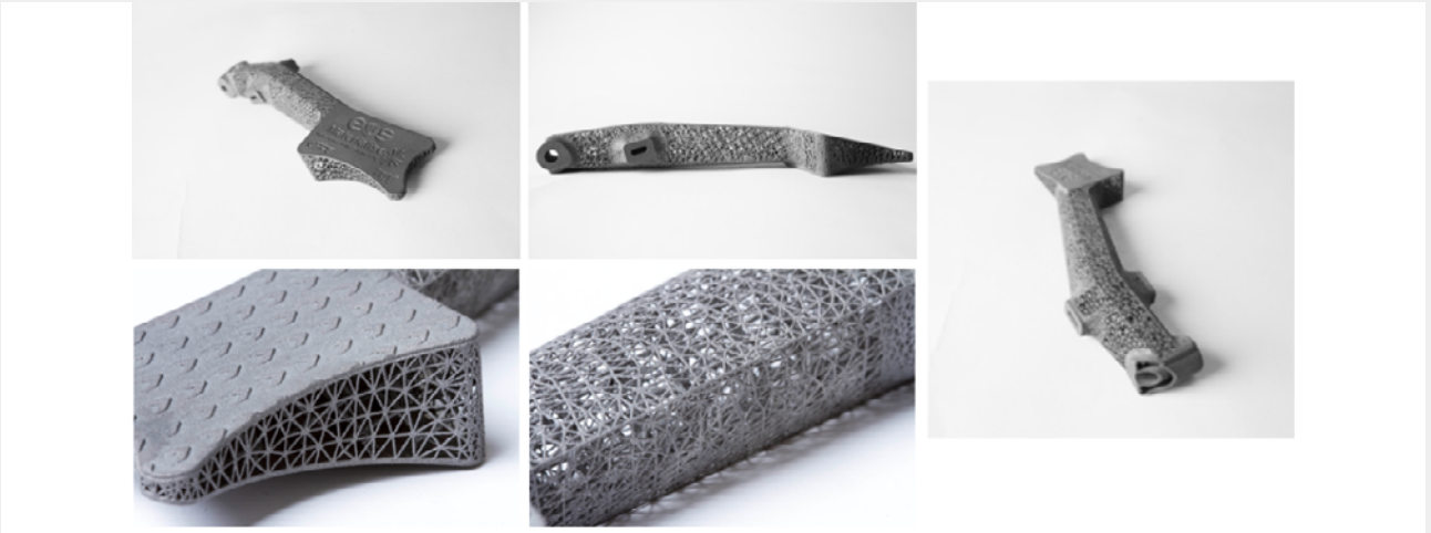
圖 4：透過使用 3-matic 的晶格結構 + 紋理模組，可設計傳統 CAD 無法設計的複雜點陣結構，甚至可在每個 STL 檔案上加入想要的紋理效果
