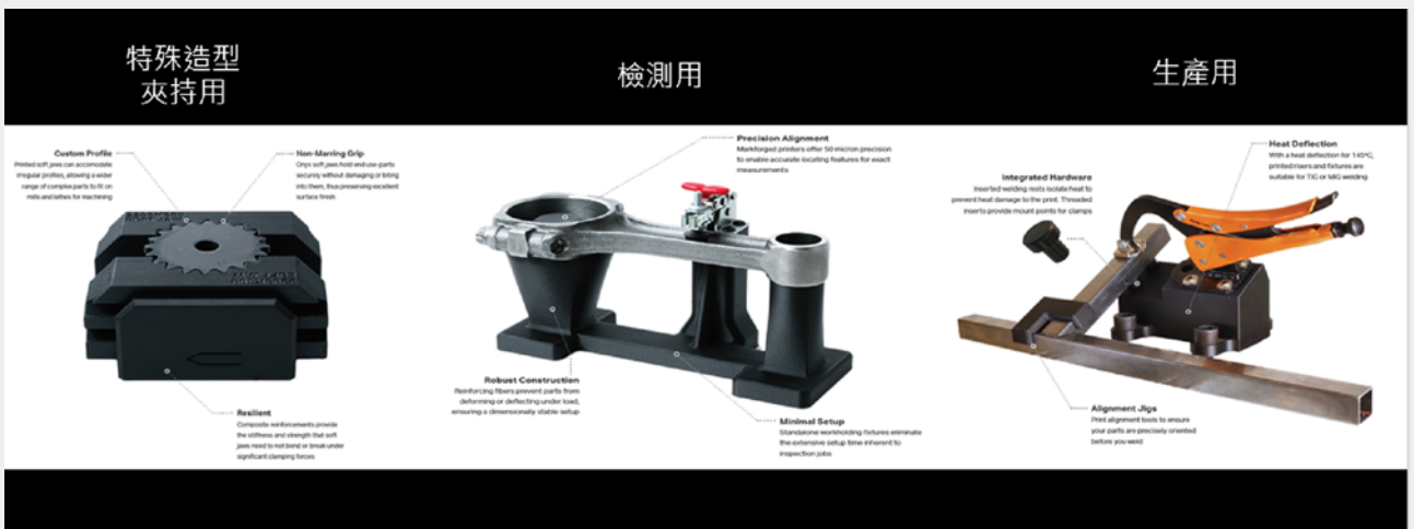
圖 8：夾治具種類，左側為夾持齒輪的治具，中間為搭配 3 次元檢測用的治具，右側為生產用的焊接治具
