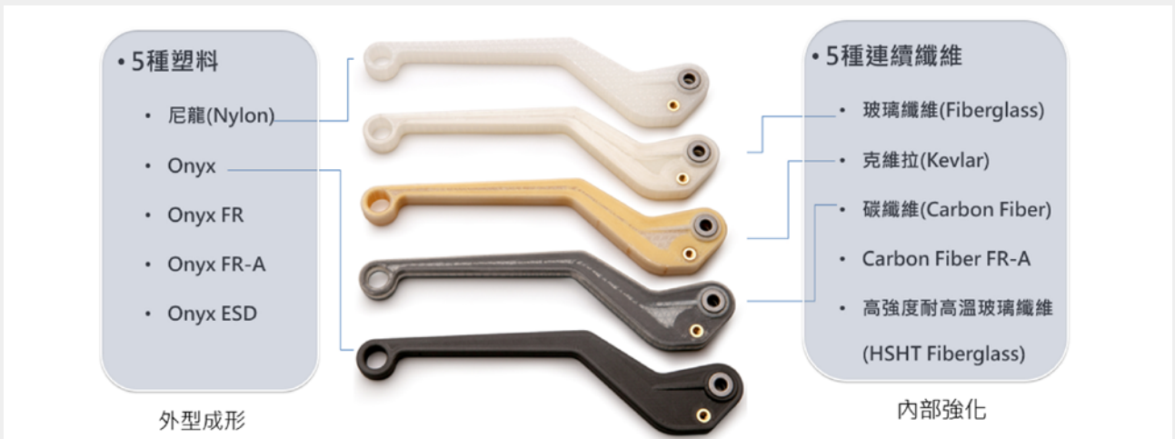
圖 7：Markforged 專用材料，左側為外型成形材，右側為內部強化的連續性長纖維
