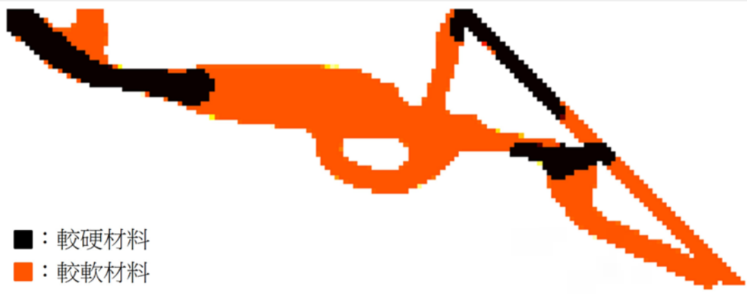
圖 3：軟性手指的拓樸最佳化設計結果
