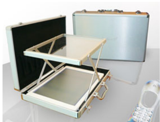
圖 10：應力偏光儀可用來檢測透明塑件的應力分佈
