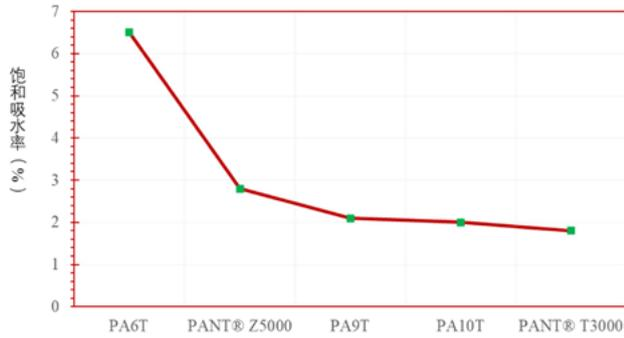
圖 3：PANT® 材料與其他 PPA 純樹脂飽和吸水率
