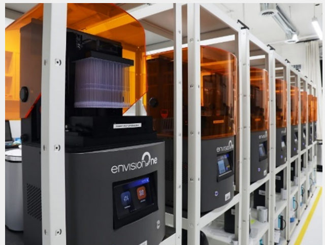
圖 7：大量生產之光固化設備
