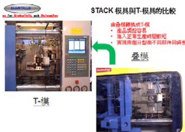
图 1-1:STACK 模具与 T- 模具的比较
