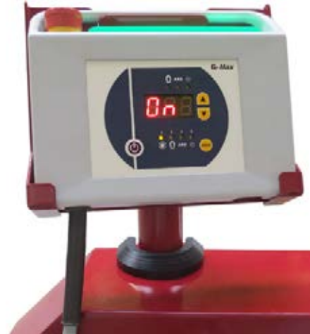
图 10:G-Max 的控制面板采用 ambiLED 显示屏，显示出粉碎机的运行状态
