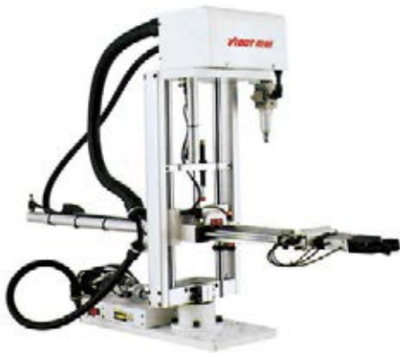
圖 2: 立式注塑机专用水口取出机械手
