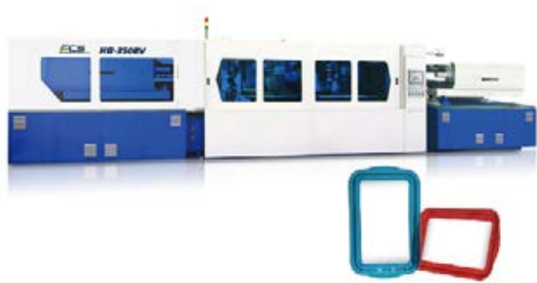
图 1: 出展的 HB-350RV 水平转盘双色机
