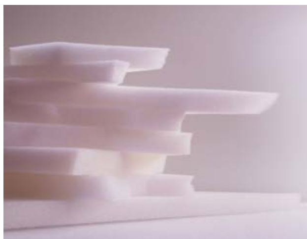
图 2: 陶氏研发的创新型增强聚乙烯发泡 (EPE) 解决方案，可以实现单位包装 10-15% 的原材料节省
