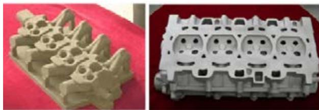
(a) 发动机缸盖气道、水套组合芯
