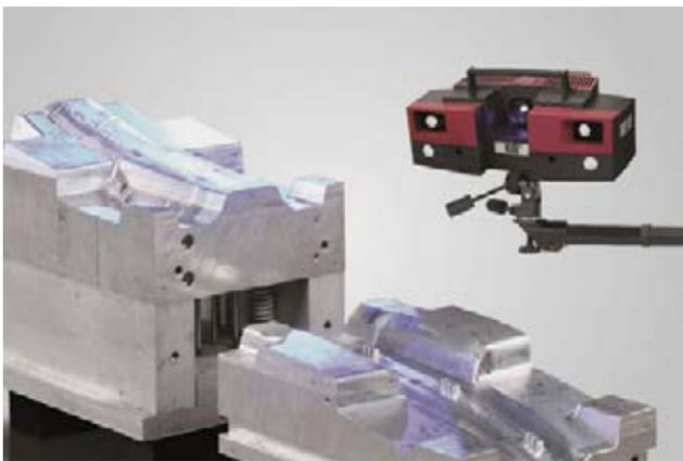
图 1: 3D 扫描精度越来越高能够达到 5~8 $\mu$ m 的精度
