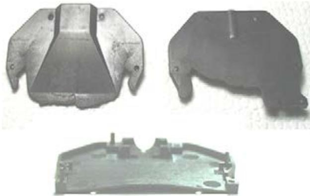
图 2: 二穴流动的差异以及填满后变形剧烈的状况
