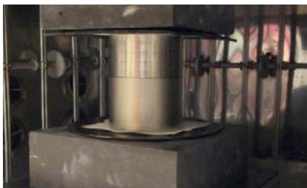
图 4: 真空热扩散焊接
