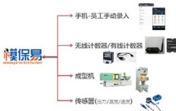
图 4：模具生产模次与成型周期支持多终端接口
