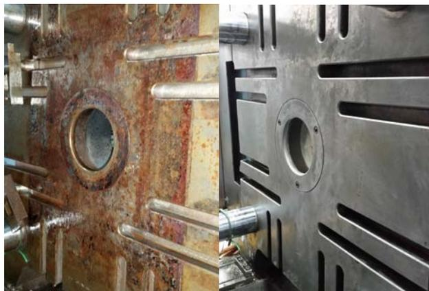
图 1: 注塑机锁模板清洗防锈对比
