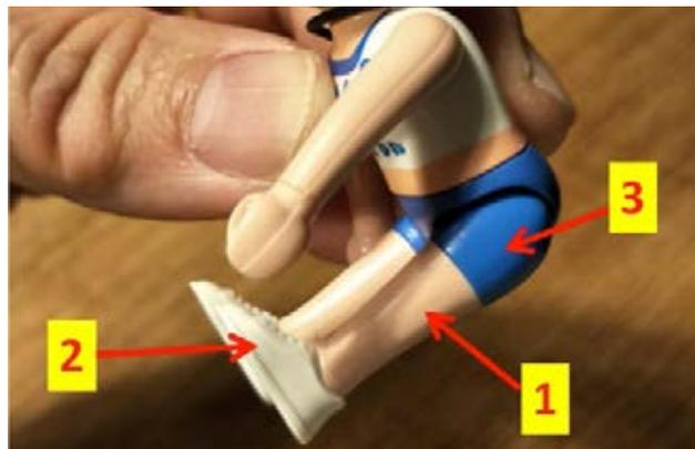
图 6: 一双人偶的脚有三色注射，显示脚部零件必须要在不同的三套模具来完成
