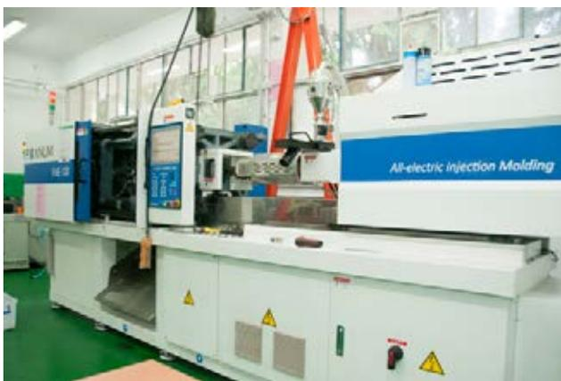
图 1: 130 吨全电式卧式射出成型机
