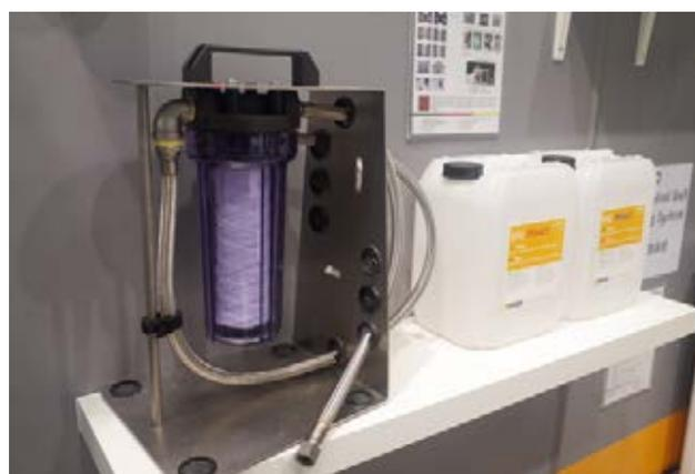
图 5: Buchem 化学品以及应用设备 (模温机清洗装置)
