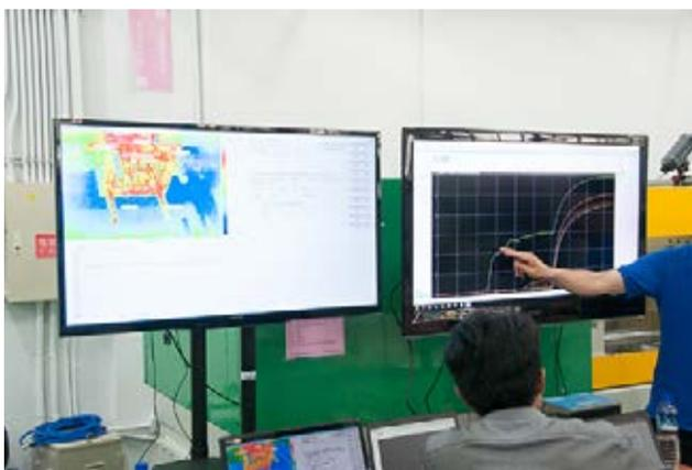
图 8: 科学试模模内压力温度检测
