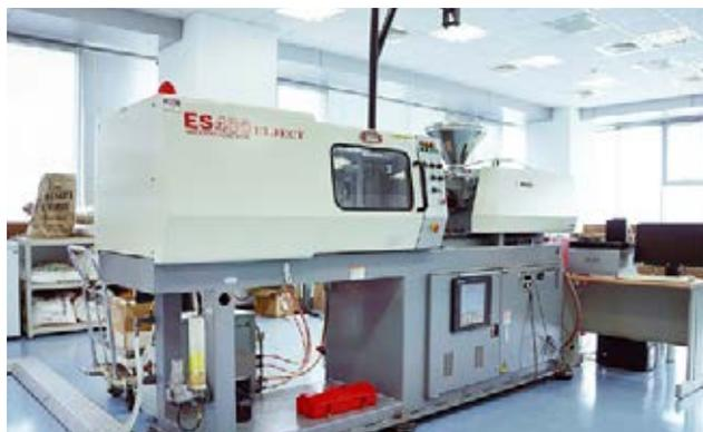
图 2: 材料研究中心量测设备: 验证模拟结果之射出机
