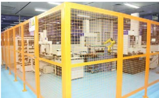
图 1: 一台机械手可配合两台三坐标测量机, 进行四个零件的测量工作, 每天连续工作 22 小时, 依然稳定、精准
