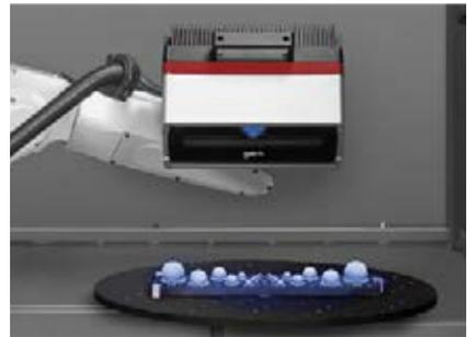
1-1 不可或缺的自动检测环节 /1-2 光学三维量测系统 /1-3 扫描零件外观形状的光学精密量测系统
