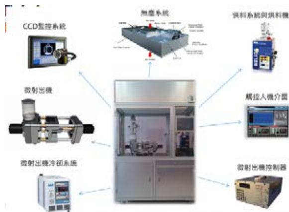
图 2：碟式螺桿微射出成型，系統整合
