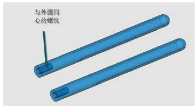
图 4: 定模板上的与斜导柱配的孔是通孔, 很容易做到精度。
