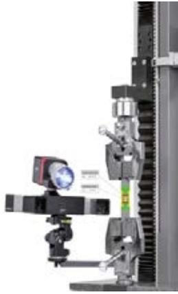
图 1: ARAMIS 光學 3D 動態量測系統
