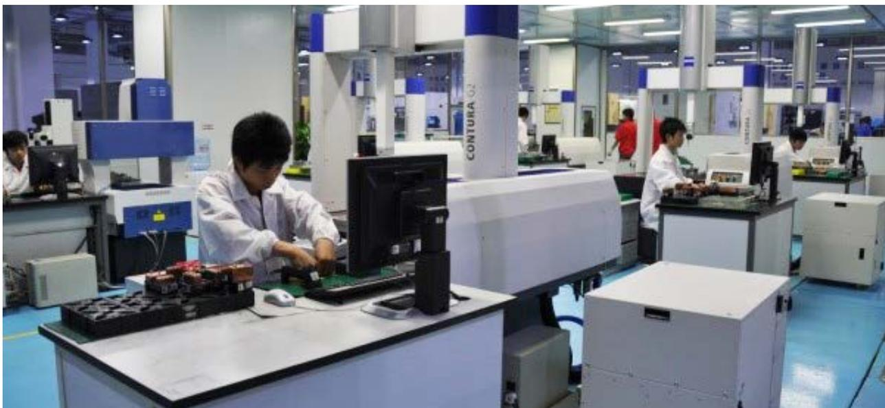
图 3: 比亚迪精密模具工厂共拥有 19 台蔡司的三坐标测量机。其中手动测量单元，每台设备每天要连续工作 20 小时
