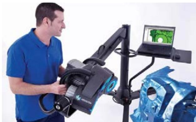
图 2: 蓝光拍照测量系统 BLAZE 600M 是一种高速、非接触光学 3D 拍照式测量解决方案。
