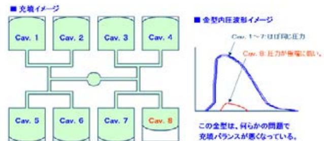
图表 7 多模穴流动平衡评估 8 个模腔中压力曲线重合度很
