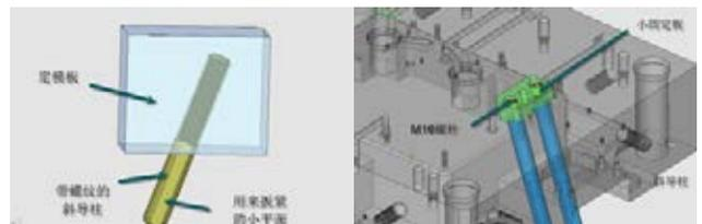
图 4: 可以在斜导柱上做螺纹, 从分型面这边旋入定模板。
