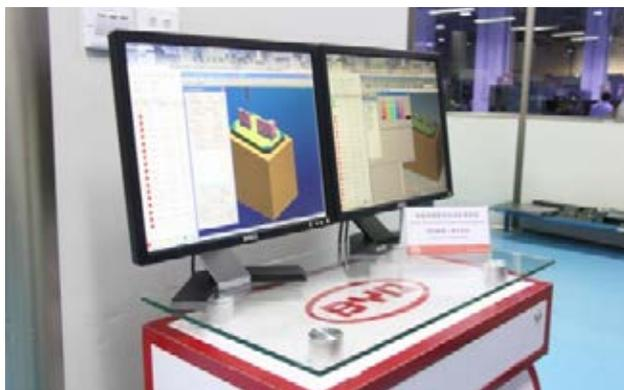
图 2: 基于蔡司测量设备之上的比亚迪自主研发的自动化编程及测量平台, 完全实现了测量工作的自动化生产
