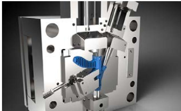
图 2：注塑模具的加工
