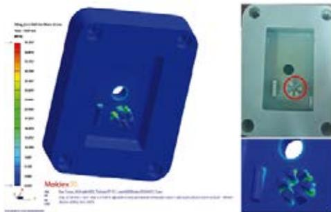
图 8：模拟分析显示塔型特征 (红色圈选处) 有极大应力分布，可能会发生实际断裂
