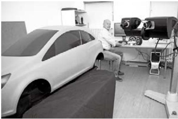
图 3: 车体制造业使用 COMET 扫描参考模型 (尤其是泥塑模型) · 然后使用这些模型通过逆向工程进一步开发
