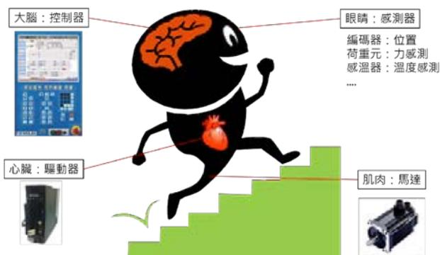
图 1: 全电动注塑机控制系统架构方面
