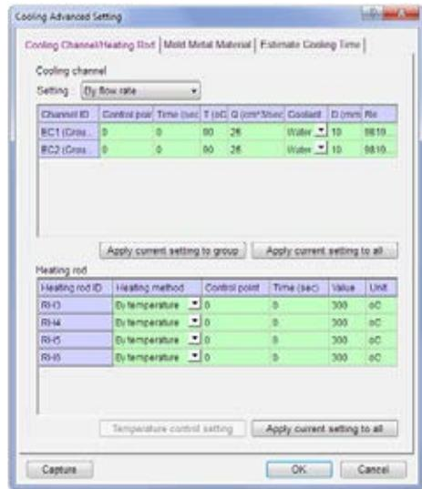
图 2：冷却水路和热浇道系统之制程设定
