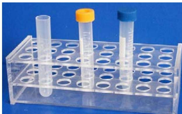
图 6: 可以用来隔离被加物的支架，就如试管架般，是磁针研磨的好帮手
