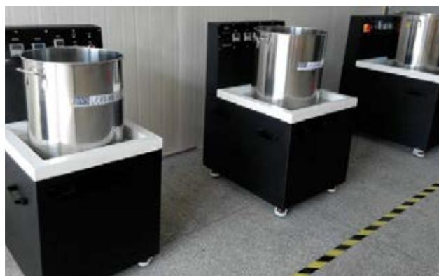
图 1: 简单的磁针研磨机的构成图，利用电动机带动磁针旋转就能工作；右图是实际的生产设备，占地很小仅约 0.5X0.5 平方米，不需要排水 / 防尘 / 排气 / 噪音防制。
