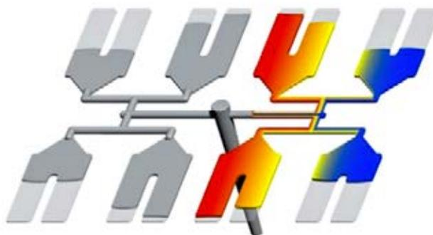
图 2：MeltFlipper™ 多模穴流道平衡技术
