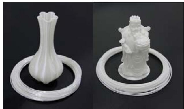
图 4：高韧性保持率 PLA 材料的颜色和打印效果及右图珠光或高光级 PLA 材料
