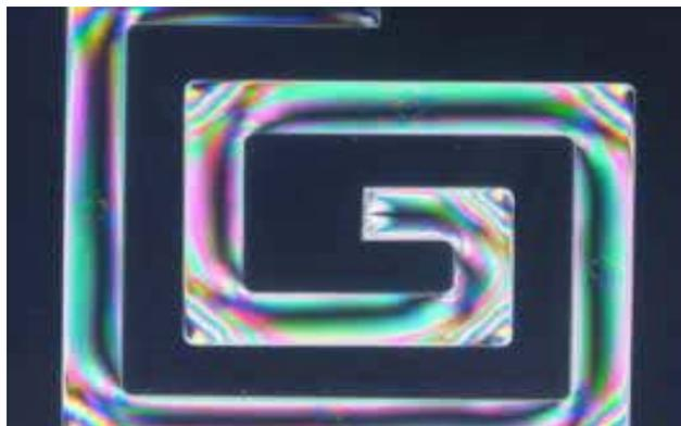
图 6：应力偏光观测可有效观察高应力区域
