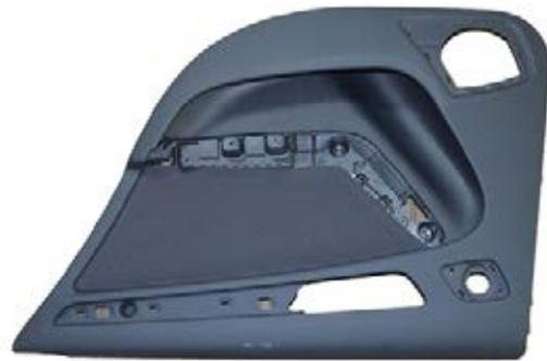
图 2：微发泡工艺技术在汽车产业的应用
