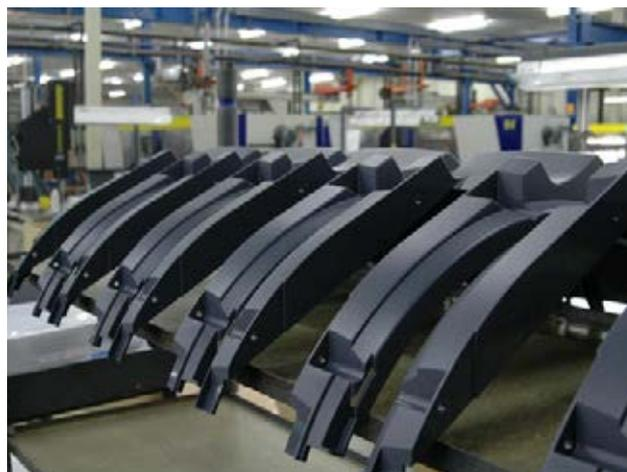
图 2：气体辅助射出成型技术已经存在了二十多年
