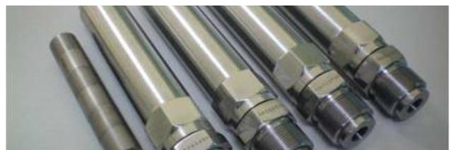
图 4: 静态混合射嘴实样
