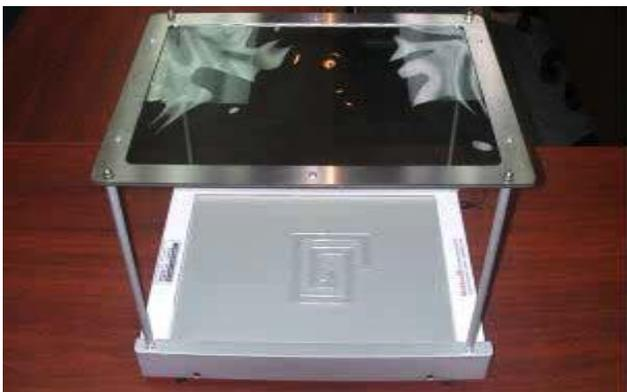
图 5：应力偏光观测装置
