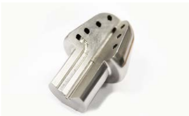
图 1：采用真空热扩散焊技术加工内部带随形水路的零件
