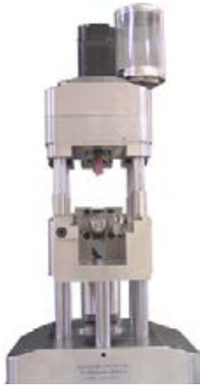
图 1：3 吨立式微射出机 (25*25*70cm)
