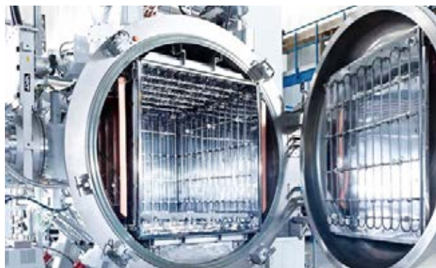
图 2：来自德国的先进扩散焊接炉
