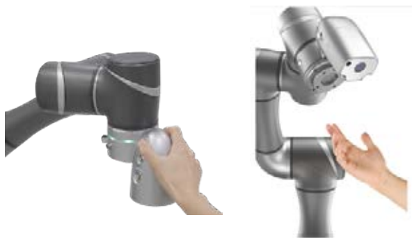
图 4：使用机器人末端的功能按键即可轻松拉动机器人，纪录点位 / 图 5：无压力操作环境
