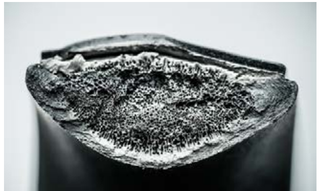
图 6：金旻微发泡 PP 材料“微孔结构”
