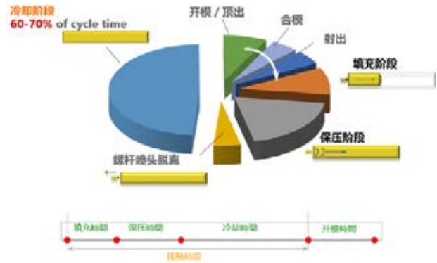
图 2: 成形周期内冷却时间所占的比例
