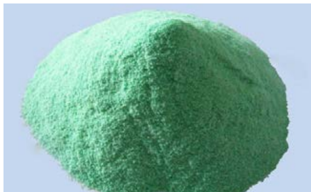
图 2：SHS 选择性热烧结成型技术材料：热塑性粉末
