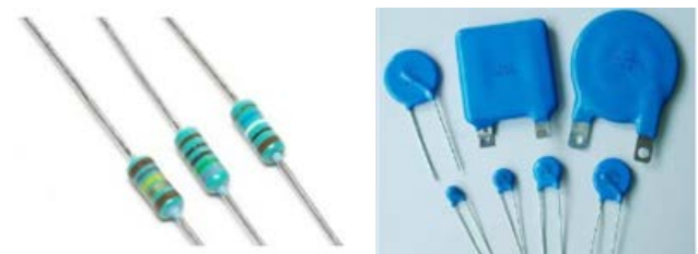
图 2: 左为陶瓷电阻器，右为压敏（电压）电阻器
