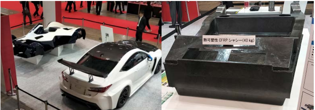
图 8：汽车减重，这是近十年不断被提及的，目的在于减轻汽车重量以提升燃料效率、节能减碳，利用 CFRP 和 CFRTP 作为主要研发的材料是日本 ICC 协会全力执行的
