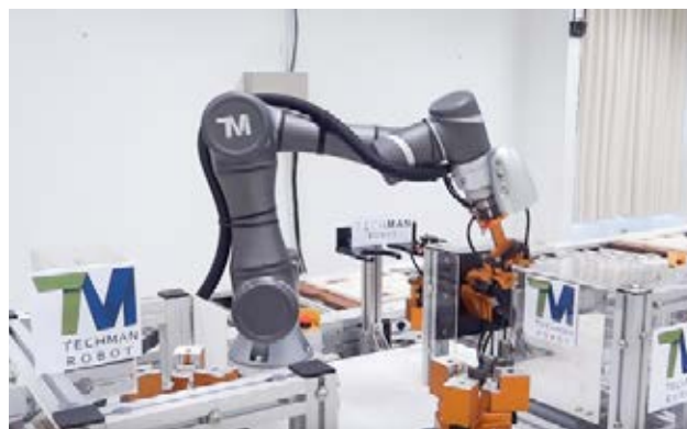
图 2: 搭配 RGK 气动组件展示机械加工上下料情境
