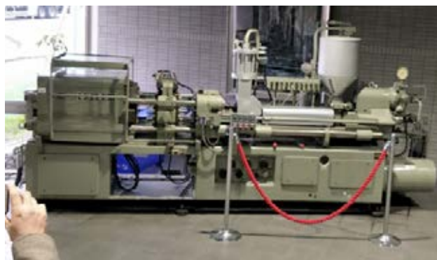
图 1：展示厅中第一代的注射机，1966 年出厂的老爷机。当时的计量调整是在炮筒上用调节活塞来执行，所有的控制都使用机械式调整。
