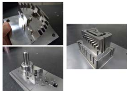
图 4: 通过复合工艺制作出来的模具效果精度可达到 \pm 0.01\text{mm}
