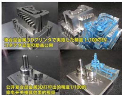
图 4：随形水路的升级 – 九弯十八拐加压扁水路（可非等断面）
