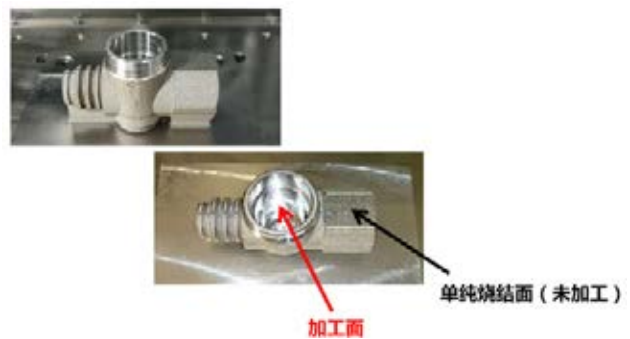
图 5: 单纯烧结和复合加工后表面状态的比较
