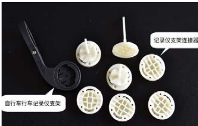
图 1：使用 3D 打印模具制作行车记录仪支架连接器
