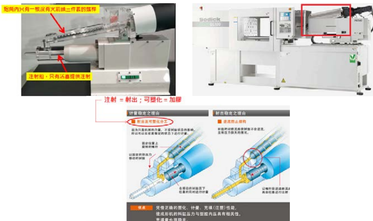
图 2：透明的 V-Line 结构为右上红色标示区域的简图；下图则为 V-Line 的工作原理，当加胶完成后，注射活塞往前进行注射时，螺杆则是向前抵死封闭防止胶料回冲加胶螺杆区域。
