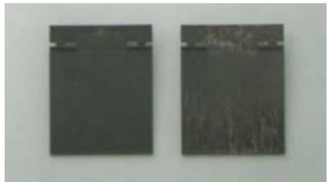
图 3：(左)未干燥的 PC PC/ABS 以排气式的注塑 / (右)未干燥 PC 以一般无排气的成形品
