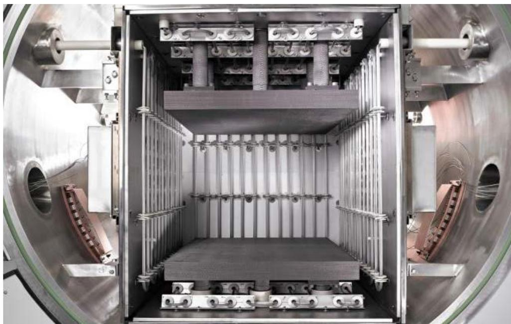
图 3：扩散焊接设备主体 (PVA Tepla AG 提供)
