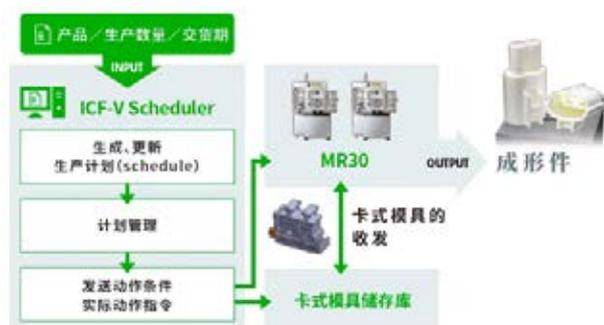
图 1：MR30 · 利用 IoT 模式生产流程
