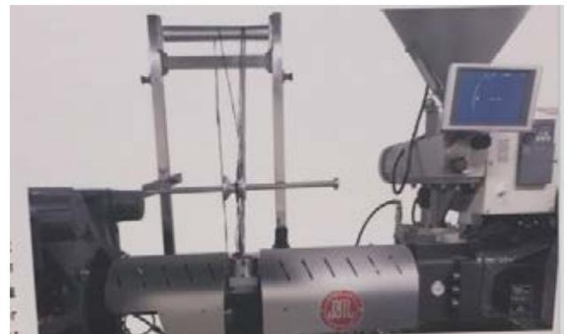
图 7：长纤维直接导入的注塑方式
