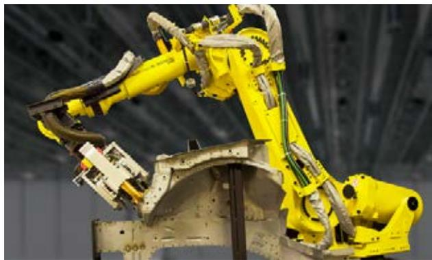
图 2：Fanuc 机器人在汽车业焊接
