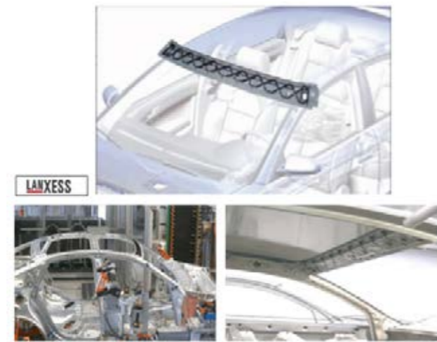
圖 6：汽車前窗上沿檔板 - 改採輕量化 NMT 的組合設計，封膠後可充分防塵防水
