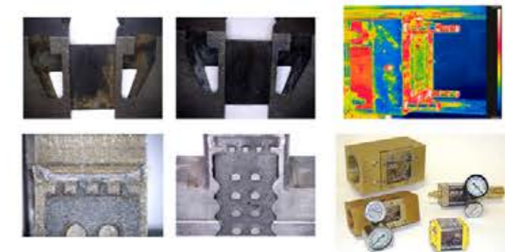
異型水路保養及在線檢測技術
