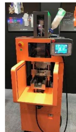
圖 3：微型射出機 - 優點：占地少、降低能耗、安全性高、適用研究或教學應用方向及趨勢：醫療、3C 電子元件、 代表廠商：新興 \ Canon \ Babyplas \ REP 等...
