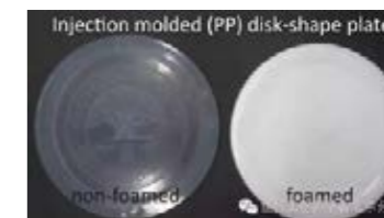
圖 3：聚丙烯 (PP) 注塑製品 (左) 和它的微孔泡沫 (右)
