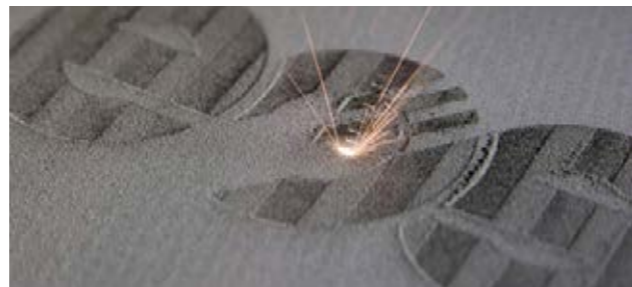
圖 1：增材製造技術 /DMLS 的燒結過程 (EOS 公司提供)
