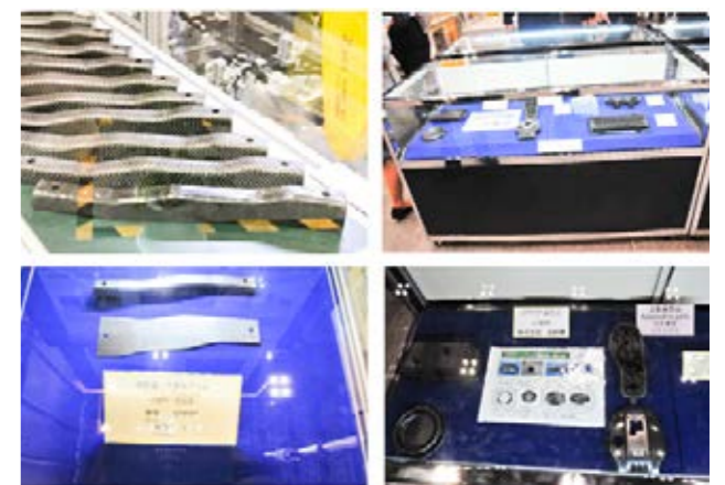
圖 2：以塑代鋼 (多家專用成型機已經出現) 纖維複合 - 長纖成型 & 纖維布複合成型 - 優點：減重明顯、成本低 應用方向及趨勢：汽機車、風力發電、船舶、航天 - 代表廠商：Trexel \ Toshiba \ JSW \ UBE 等...
