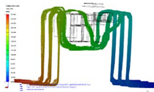
圖 2：隨型水路的流線及長度分析 (Moldex3D/ 型創科技公司提供)
