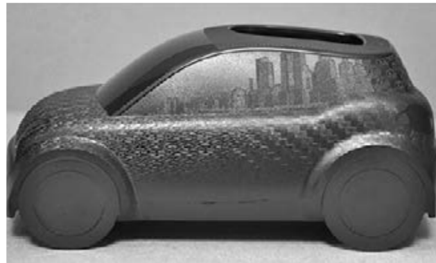
圖 4：應用動態模溫控制技術改善 MuCell 微細發泡成型表面品質，同時展現表面紋路之高轉寫性效果 (資料來源：注塑世界雜誌 2017 年 10 月號，此樣品生產實際展示於 Fakuma2017Milacron 注塑機展位)
