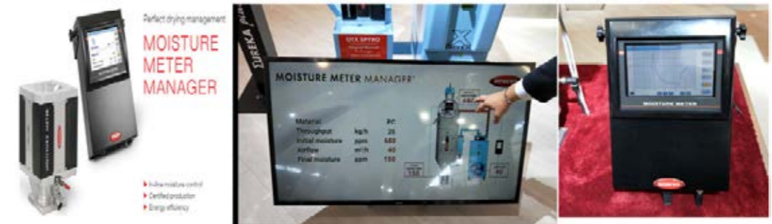
圖 8：MorettoFakuma2017 展會現場展示塑料含水率線上實時量測與歷史軌跡曲線
