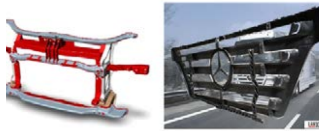
圖 4：朗盛科技想到的減重方案首先針對無關生命緊要的汽車零部件，並獲得汽車大廠的認可 - 在大卡車的進氣口遮蔽罩，減少了約 10kg 的重量
