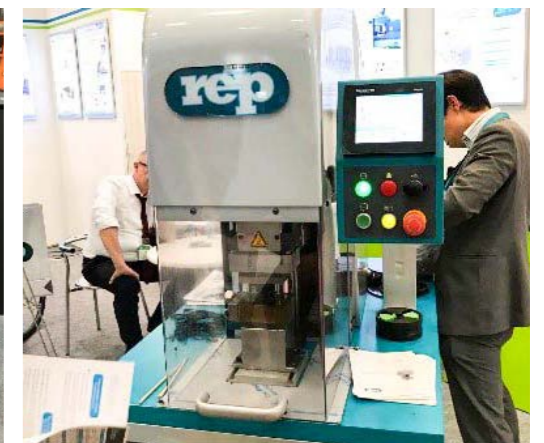
圖 3：微型射出機 - 優點：占地少、降低能耗、安全性高、適用研究或教學應用方向及趨勢：醫療、3C 電子元件、 代表廠商：新興 \ Canon \ Babyplas \ REP 等...
