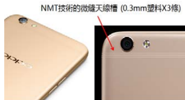
圖 2：智能手機 OPPOR9S&R9SPlus 的微縫天線設計 (圖片取自 OPPO 網頁)，該設計的三條細縫是採用平行的三片圓盤刀所具切出來，這真是機械加工的極致工藝
