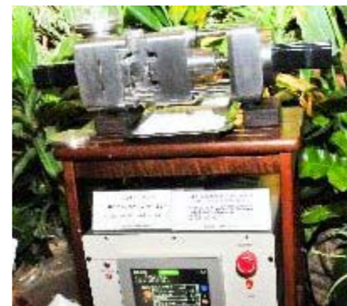
圖 3：微型射出機 - 優點：占地少、降低能耗、安全性高、適用研究或教學應用方向及趨勢：醫療、3C 電子元件、 代表廠商：新興 \ Canon \ Babyplas \ REP 等...
