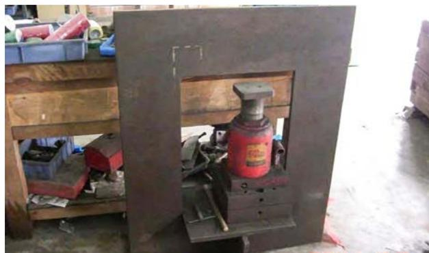
圖 2: 冷擠壓夾具
