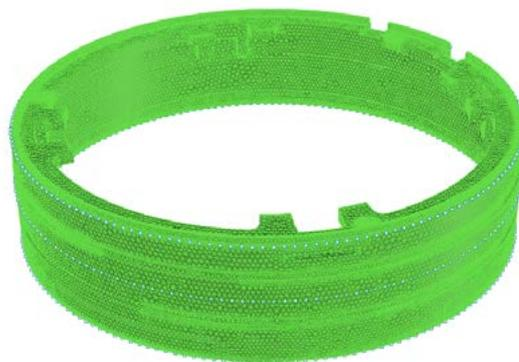
圖 1：纖維排向與塑料流動方向相同 (Z 軸方向)
