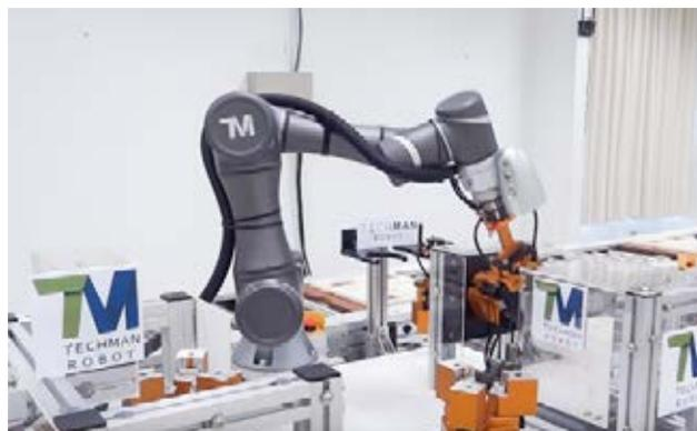
圖 2: 搭配 RGK 氣動組件展示機械加工上下料情境
