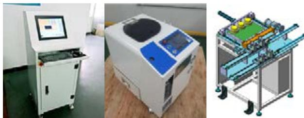
圖 10：氣密性檢測設備、自動拉釘機、智能伺服移印機
