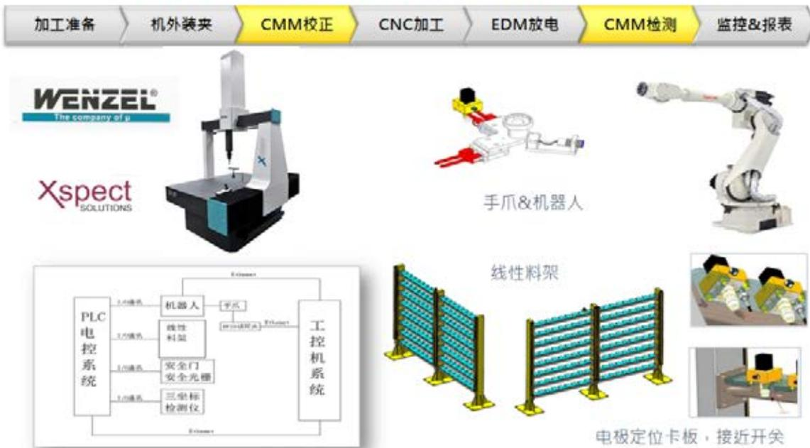
圖 4: 模具製造測量解決方案
