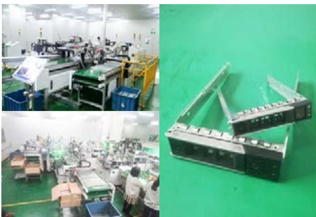
圖 6：(左) 2.5 吋伺服器硬碟支架全自動化生產線、3.5 吋伺服器硬碟支架全自動化生產線及硬碟支架產品
