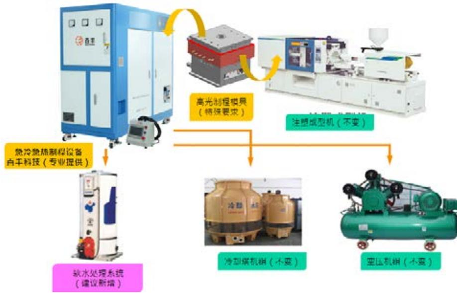
圖 3：急冷急熱變模溫之設備配置
