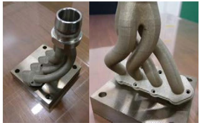
圖 3: OPM 研究所製作的 Inc718 產品
