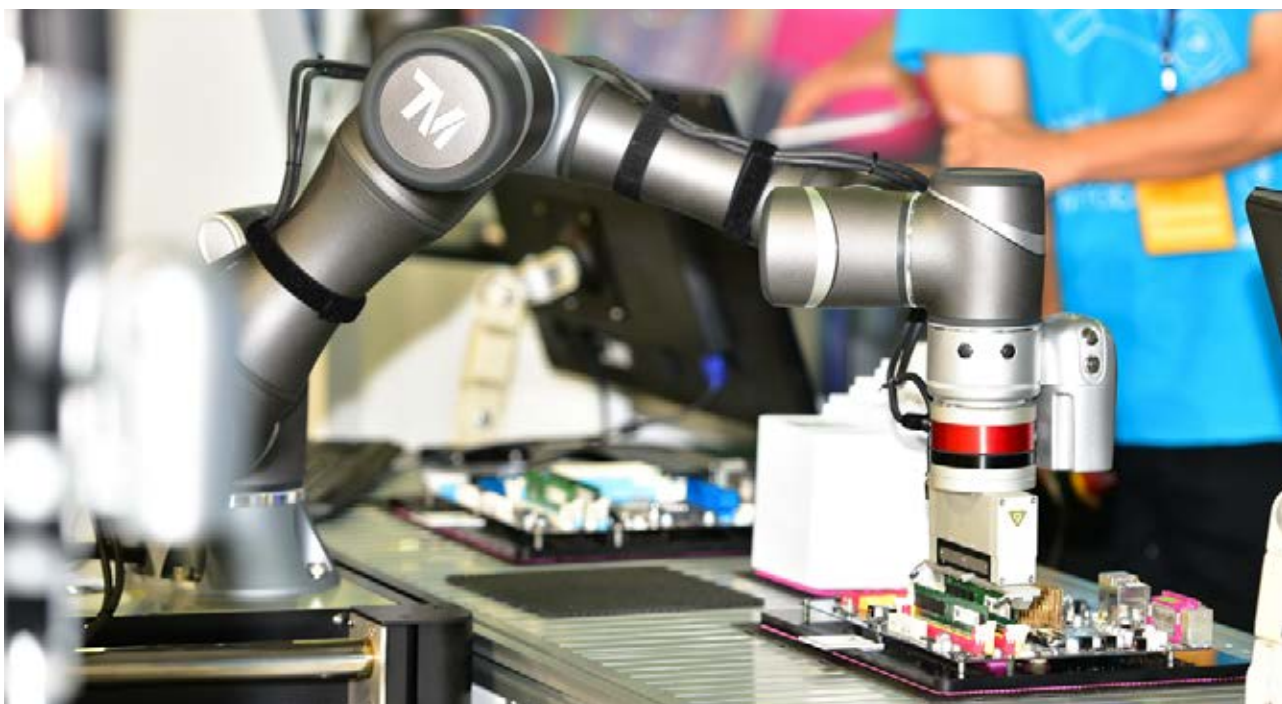
圖 3 :以獨家 TM Landmark 定位技術，在外來物靠近時自動放慢或停止手臂的視覺辨識安全範圍，呈現達明機器人手、眼、力的最佳整合。
