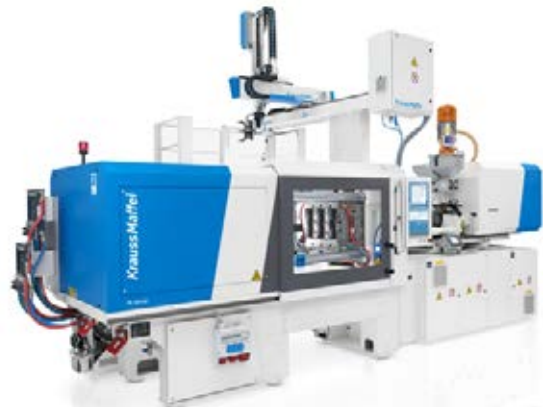
圖 2: Flip Top 翻蓋的更高產速：全電動 PX 160-540 在中國國際橡塑展上生產飲料工業用薄壁封蓋
