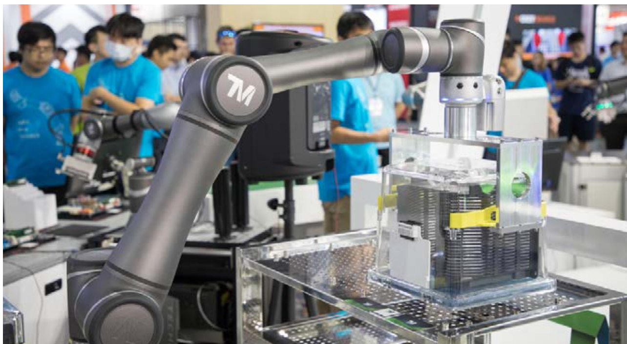
圖 2：內建視覺協作機器人 TM5，進行物件取放加工作業，並應用 ACF 進行力回饋拋光研磨
