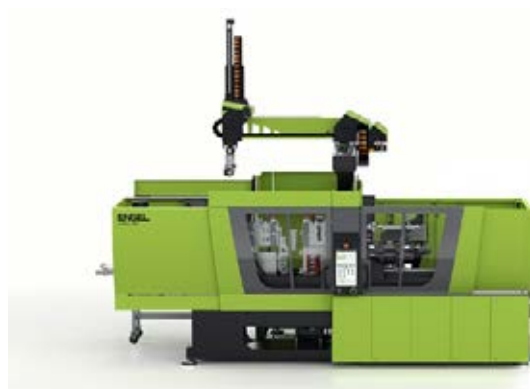
圖 2: 多虧了無菌的閉合單元，無橫樑 e-victory 射出設備在加工液態矽膠時具備巨大的效能潛力
