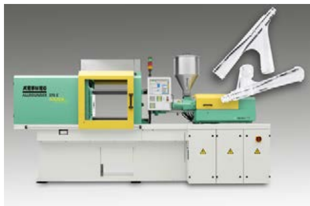
圖 2: 在 CHINAPLAS 2018 上，一台 Allrounder 370 E Golden Electric 生產用於輸液治療的 Y 型連接部件
