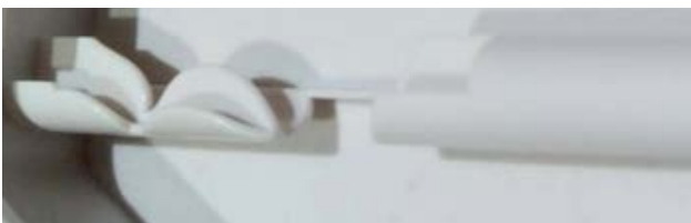
圖 8：模流分析可以預測對薄肉區，容易產生滯留造成短射並提供合理的肉厚設計值
