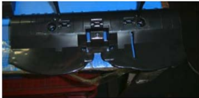
圖 4: 實驗 (上排圖) 和模擬 (下圖) 流動波前在充填 2 秒的比對
