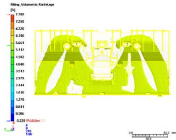
圖 3: 在輔助氣體注入時，體積收縮率等位面分佈模擬結果
