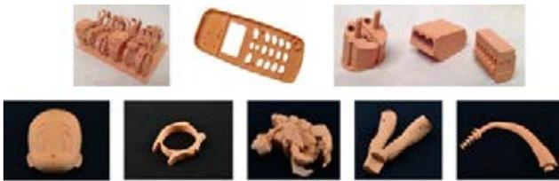
圖 4：紅蠟 - 德國 EnvisionTEC 專用光敏樹脂；精度可達 0.02mm；主要用於精細結構產品驗證，以及失蠟鑄造；主要應用：鐘錶、玩具、珠寶首飾等
