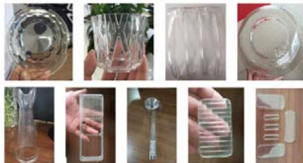
圖 2：透明光敏樹脂，表面處理後，可以達到透明效果
