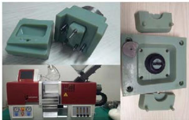
圖 3：耐高溫光敏樹脂，耐高溫樹脂可以直接快速打印成模具，在射出機上射出
