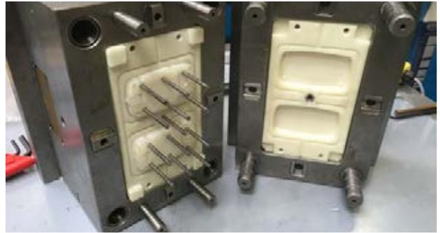
圖 2：金屬 3D 打印成品可應用在模具的開發上
