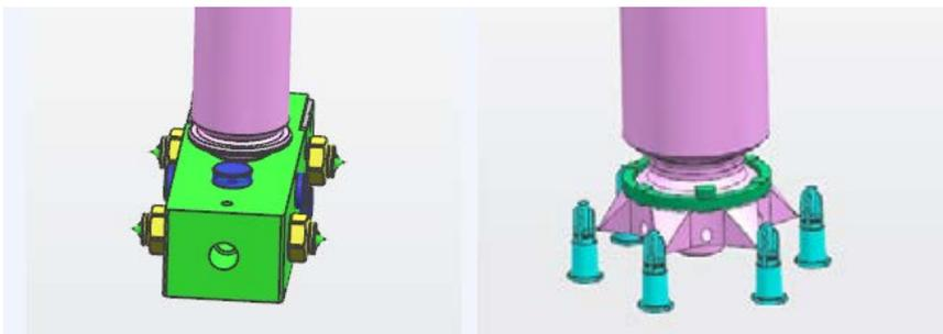
圖 4 : ( 從左至右 )1. 分流塊形式 ( 開放 ) / 2. 爪子形式 ( 開放 ) / 3. 針閥形式
