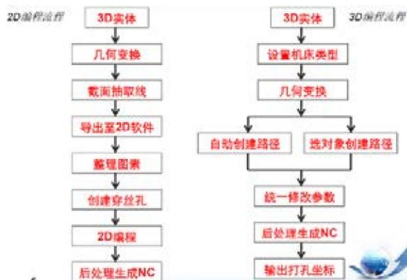
圖 4: 2D 編程及 3D 編程流程圖
