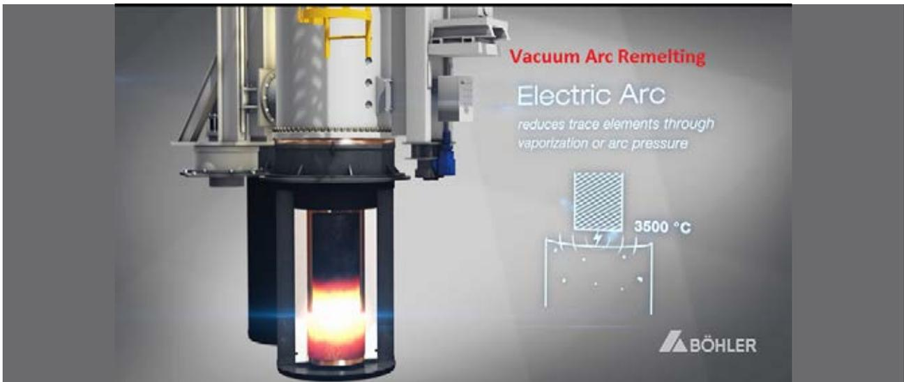
圖 1：真空電弧重熔精煉 (Vacuum Arc Remelting, VAR)[1]
