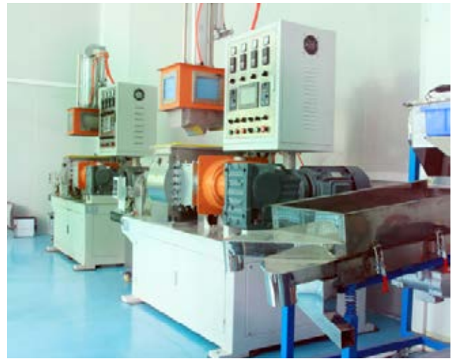
圖 2：互易隆混煉造粒一體機是最早實現 MIM 餵料的單機兩個製程結合的設備，連續混煉與造粒程序減少了工作上搬移餵料團塊的風險，也是業界體積和佔地面積最小的設備
