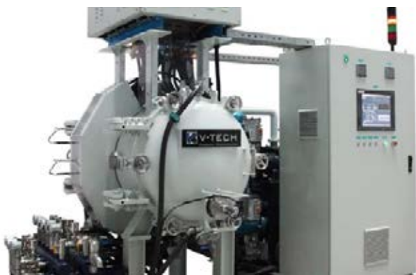
圖 1：宏倫科技的迷你實驗真空脫脂燒結快冷爐，體積雖小但功能齊全，可以實現醫療等級的 MIM 小零件整爐達 10 萬件的燒結，也是未來金屬 3D 打印後製程專用的脫脂燒結爐
