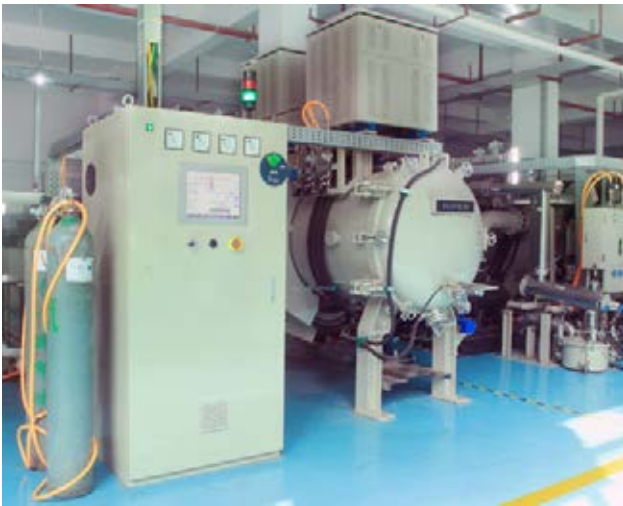
圖 1：恆普真空是大陸自有品牌，他們的批次式石墨真空脫脂燒結爐的市佔率超過 70%，第一家把沉重的變壓器“背”起來，為客戶節省了佔地空間
