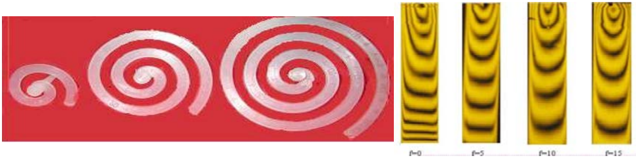
圖 2：左 - 是填充流動於紋香模穴中，動態注射使餵料流動變長；右 - 為震動能量越大，透明件的光干涉紋越寬，應力累積越小
