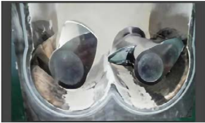
圖 2：左：傳統閉合式腔體的死角位於兩支攪拌螺桿與腔體交連下方，混煉過程結束有一片餵料幾乎沒有移動沾黏其上；右：為更易隆設計的腔體，在“死亡三角”位置式一根可以正反轉的擠出螺桿，克服了餵料停滯的風險
