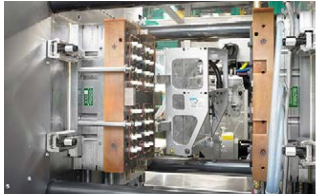
圖 4: Rico 公司在無塵室製造護罩的模具
