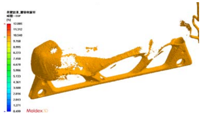
圖 6: 保壓結束的動態體積收縮率分佈，末端值相當大
