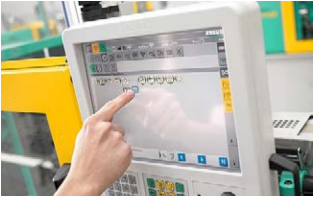
圖 3: 利用 Selogica 控制系統，複雜的過程也可方便安全地編程
