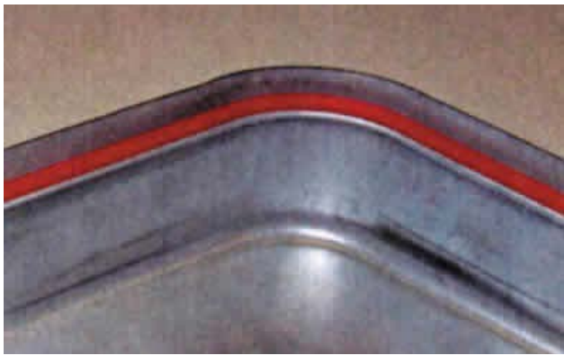
圖 3: 將 LSR 塑料包覆成型到金屬材質上，是另一新的應用領域
