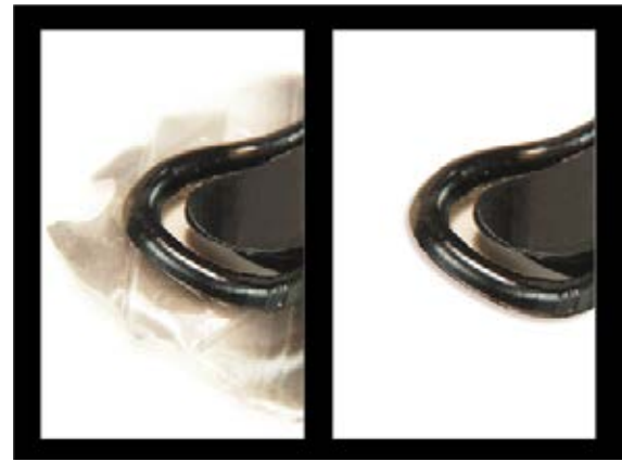
圖 2: 在某些情況下，LSR 容易閃爍小至 0.005mm 的間隙
