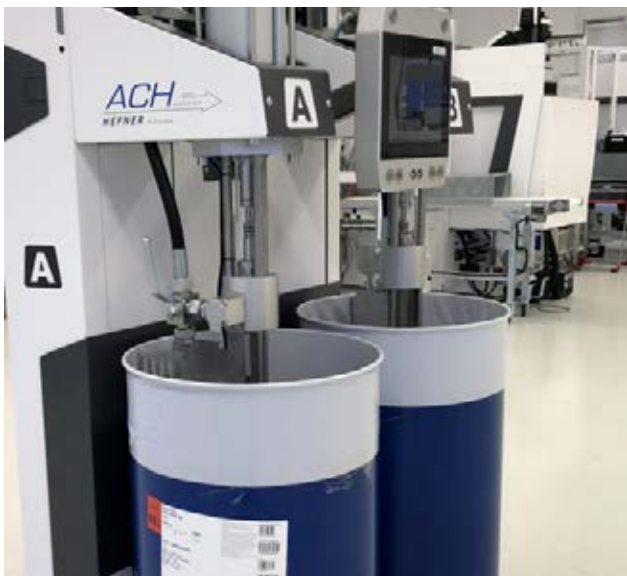
圖 2: 對於液體矽膠的配料，使用 ACH-Solution 的 MaxiMix G2 型設備。通過 ENGEL 注塑機的 CC300 控制面板，可以輕鬆控制整個工藝過程
