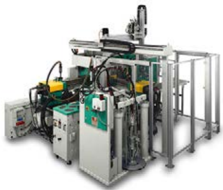
圖 1: 用 LSR 和熱塑生產雙組分部件交鑰匙解決方案
