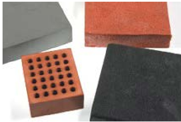
圖 6: 矽橡膠特性 (耐蒸汽)- 長期放置在水中後矽膠僅吸收 1% 的水分，而其機械強度或電氣特性不會受到影響。一般情況下，矽膠在大氣壓下與蒸汽接觸不會退化
