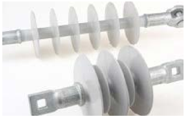
圖 12：矽膠用於高溫下的絕緣材料，它有著優越的絕緣性能。它特別出名的性能是寬範圍的溫度和 1014\Omega\cdot\text{cm} 與 1016\Omega\cdot\text{cm} 之間的體積電阻率。矽膠在潮濕環境下性能會發生最小的變化，最適於用做絕緣材料。通過添加特殊的導電填料，也可生產導電矽
