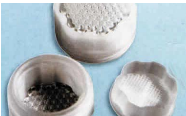
圖 1: 熱塑性塑料 /LSR 包覆成型產品應用於水龍頭上的濾網。此產品中作為濾網的 LSR 塑料被 PA66 塑料所共射包覆
