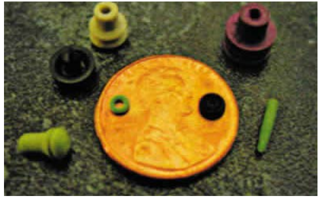
圖 6: LSR 微小成型品，射出產品重量可小到 0.0001g。Roembke 公司製造此種 LSR 微小件與微型模具
