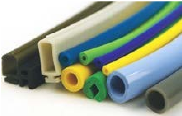
圖 11：矽膠的耐冷性在有機橡膠中是最佳的。它提供生產矽膠的關鍵原因。天然的和普通的橡膠顯示其在不同溫度下會發生比較大的形變。在高溫下它們會變軟，而在低溫下則變硬，所以它們無法再使用。
