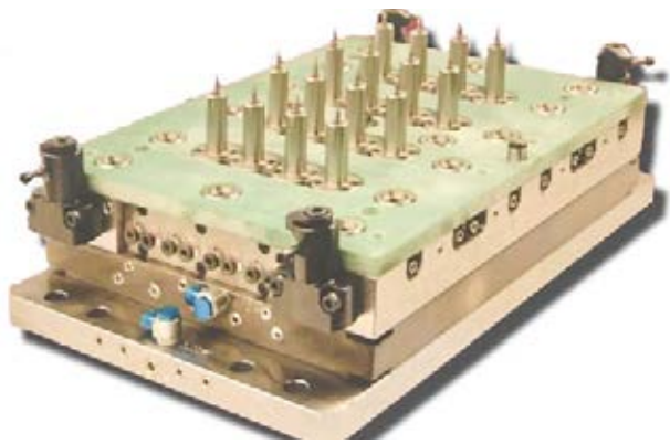
圖 7: LSR 模具使用保溫覆蓋物，能夠使冷流道和熱模具之間產生絕熱效果。該模具另一個普遍性的特徵是採用閥針式澆口，並可以進行流體流量的調節
