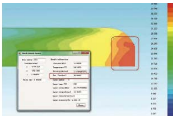
圖 3: 新支管流道流道端部滯留時間圖
