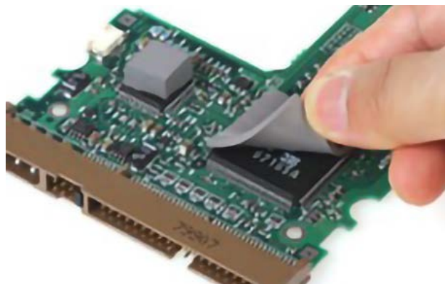
圖 14：電磁波吸收 - 隨著電子設備集成化及小型化的快速發展，在各種電磁環境中，EMC 正在成為主要爭論焦點。電磁波吸收體是將高性能金屬粉末充入矽膠中製造而成。電磁波吸收體是吸收入射的電磁波噪聲，將其轉換成熱並消除的電波吸收體
