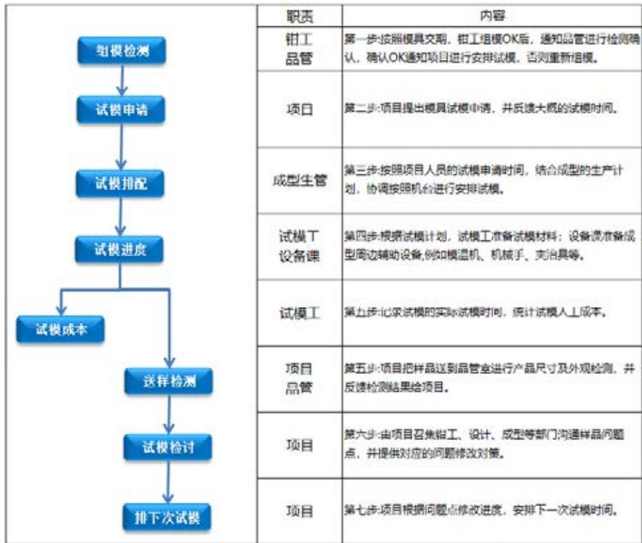
圖 1: 通用型試模流程
