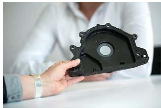
圖 7：帝斯曼工程塑料 - ECOPaXX 生物曲軸蓋—大眾汽車
