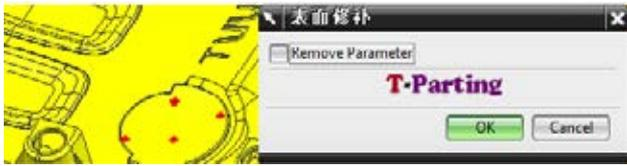
圖 6: 根據分析結果自動析出分型線，可對分型線進行編輯，並可添加手工生成的輔助面，自動設定型芯型腔顏色。對碰穿、插穿的曲面進行補片
