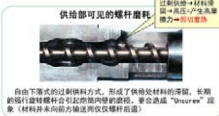
自由下落式的过剩供给方式, 形成了供给处材料的滞留, 长期的强行旋转螺桿会引起熔筒内壁的磨损, 更会造成“Unscrew”现象(材料并未向前方输送而仅仅螺桿后退)
