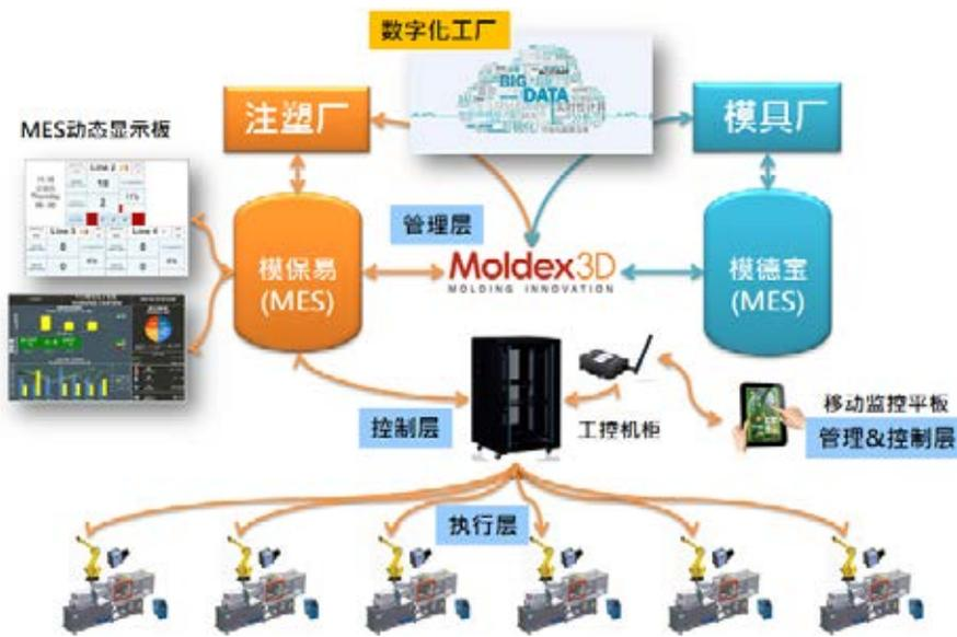
圖 8: 模具成型工廠全面信息化閉循環體系
