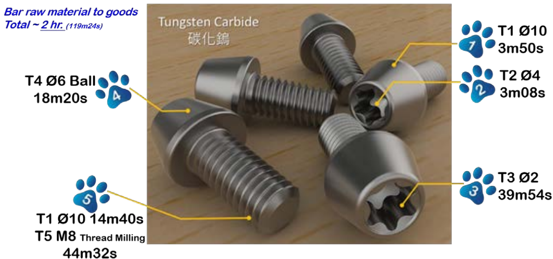
圖 7：以超音波加工技術應用於鎢鋼加工的實際案例（二）
