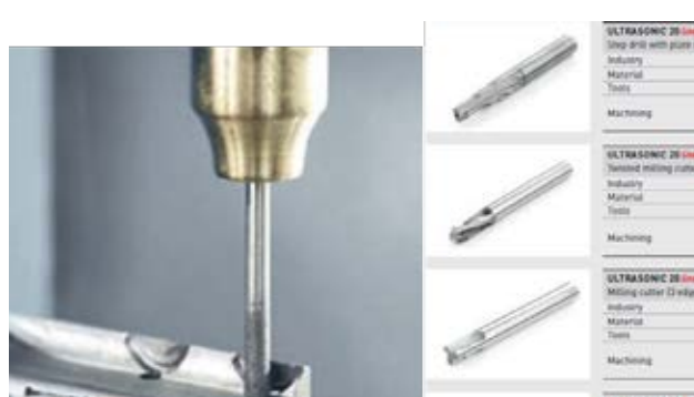
圖 5：DMGMORI 將超音波加工技術應用於刀具體結構加工的案例
