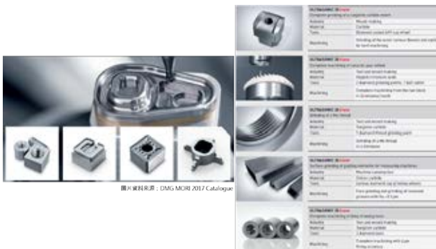
圖 4：DMGMORI 將超音波加工技術應用於模具加工案例
