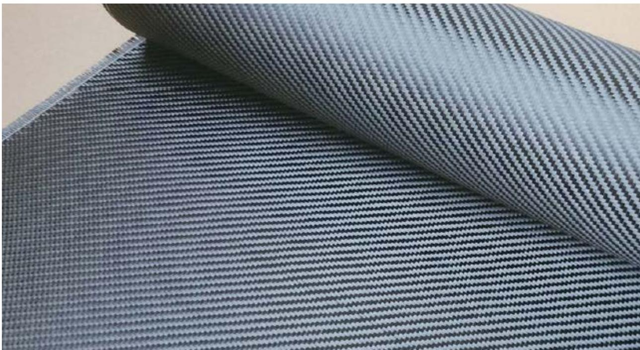
顯的缺陷，限制了其在汽車和航空航天工業中的大批量使用。一種方法是採用乾燥的碳纖維絲束編織成織物，用熱塑性樹脂薄膜將織物分層，然後加熱並壓製成複合材料。
