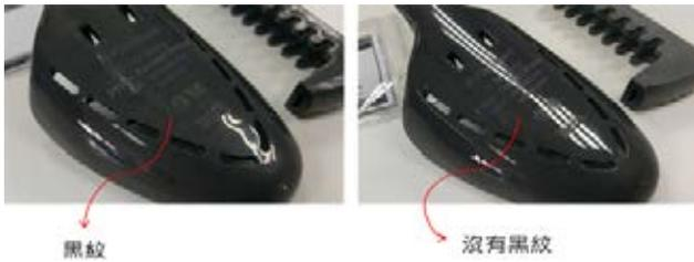
圖 3：急冷急熱工藝的好處
