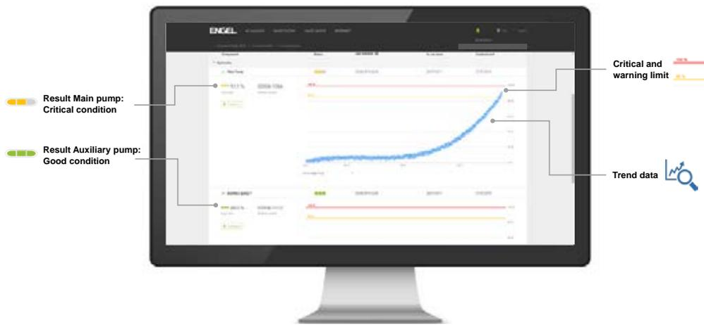
圖 4：液壓油和泵的狀態（如屏幕截圖所示）清晰顯示在 ENGEL e-connect 客戶門戶上。系統可以自動發送狀態消息和警告消息。圖片：ENGEL
