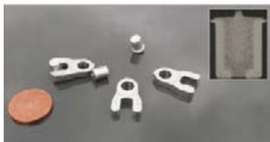
圖 10：渦輪增壓器調節桿和銷由 2C-MIM 製成。這些零件結合了可焊接不銹鋼和耐磨鈷合金（由 Schunk Sintermetalltechnik 提供）
