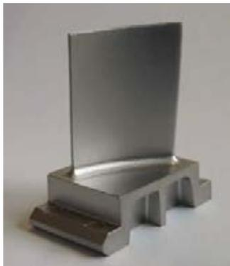
圖 14：飛機發動機的壓氣機葉片。
