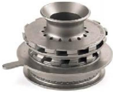
圖 13：該旋流器設計用於飛機發動機的燃燒室，並使用綠色機械加工來製造非常小的孔，並通過燒結接合來製造多個綠色零件的裝配 (禮遇聯盟 -MIM)
