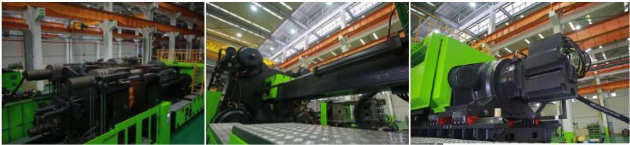
圖 1：伊之密開發的帶電動熔膠的最大射台——75500
