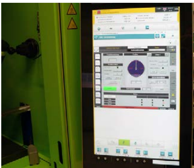
圖 3：無論模塊數量有多少，整個工藝過程都可以通過 insert 射出機上的 CC300 控制單元進行可視化和控制。(圖：MMS)
