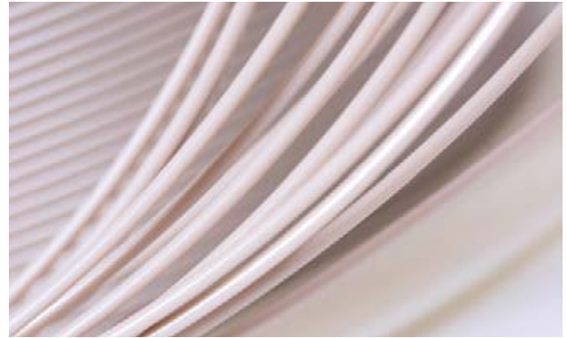
圖 2: 贏創開發的 PEEK 長絲，可用作植入物的 3D 打印材料
