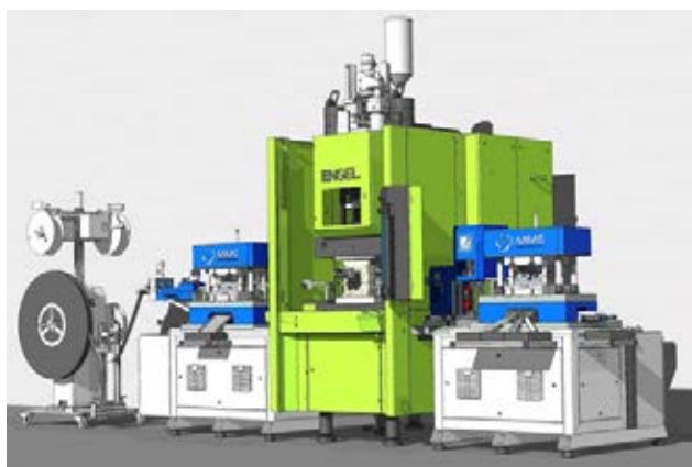
圖 2：用於製造熱敏開關外殼的原材料直接從卷軸送入並預衝壓，包括內嵌螺紋攻絲。(圖：ENGEL)
