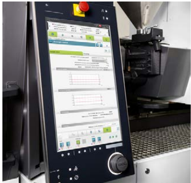
圖 4：射出機的控制系統越來越智能化。借助 iQ weight control 等輔助系統，射出流程能夠不斷進行自我調節
