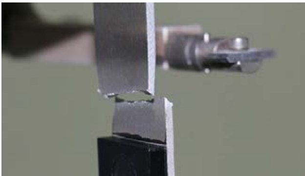
圖 1 : DIN EN 1465 標準的拉伸剪切試驗試樣 ; AKROMID®B3GF 30 7 PST 和鋁 6061 的粘合 ; 鋁材的斷裂部 · ISO 19095-3 標準的壓縮剪切強度測試 Fig1 : Tensile shear test specimen to DIN EN 1465; AKROMID® B3 GF 30 7 PST with aluminum 6061; break in the aluminum, compression shear test to ISO 19095-3 公司應用工程主管
