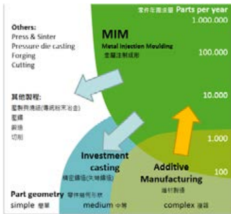
圖 9：金屬注射成形 (MIM) 與金屬增材製造 (Metal AM) 能夠互相補充不足，尤其在複雜產品的製造
