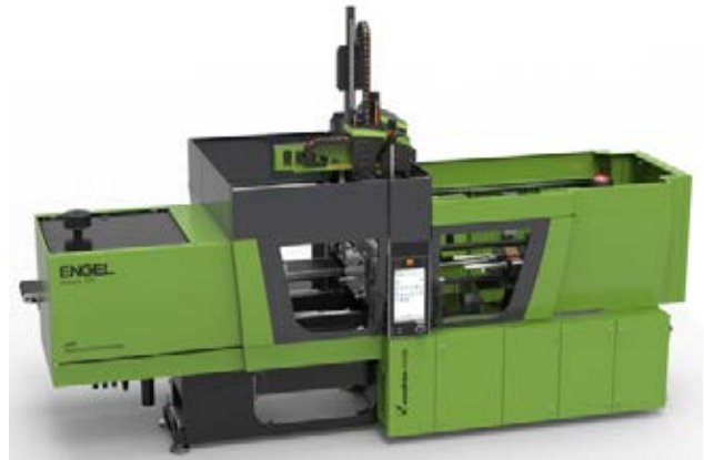
圖 2：S 為加工 Amloy 材料，Engel 專門開發了液壓 victory AMM 射出機。圖片來源：ENGEL
