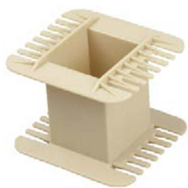
圖 4：30% 玻纖增強紅磷阻燃 PA66 線圈骨架
