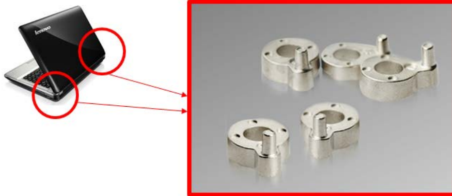
圖 2：筆記本電腦上的凹凸輪，是利用耐磨的鐵系合金和工具鋼製造而成，藉由 MIM 可製作三維度的造形達到螢幕的任意角度停止，自動閉合與限位的作用，這是典型凸輪機構的代表（照片取自晟銘電子科技網頁）
