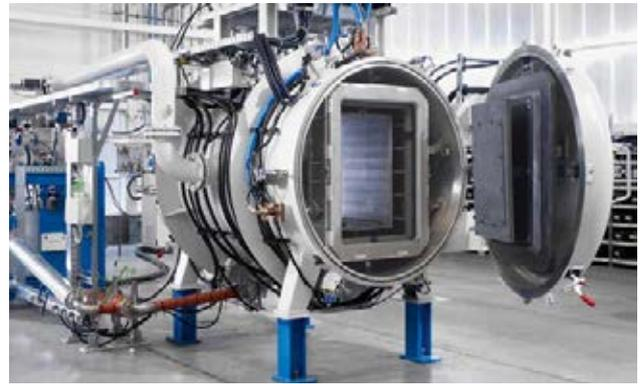
圖 2：來自德國的先進擴散焊接爐
