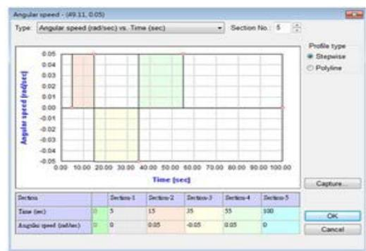
圖 2: 模具旋轉製程參數設定：旋轉周期和角速度
