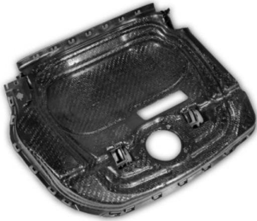
模具中加熱並製造預成型複合材料產品，並通過注射成型的方式使這些產品具備了多種功能。這簡化了後續組裝，並大幅節省了生產成本。」HPM TEPEX 汽車組的專案經理 Sontag 評論說。除加強筋之外，用於將閘座蓋固定到位的管道槽以及許多夾持器和導向器（如用於座椅通風和電纜夾持器）都被整合到元件中。連接座椅外殼的夾子也是直接插進去的。「使用夾子可以又好又快地組裝外殼，且無需使用螺釘，然後再次拆卸以進行維修。這些夾子非常穩定，並且符合所有相關的安全要求。」Sontag 補充道。
