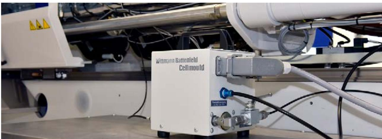
圖 3：MacroPower 1100 射出機上的 CELLMOULD® 模塊
