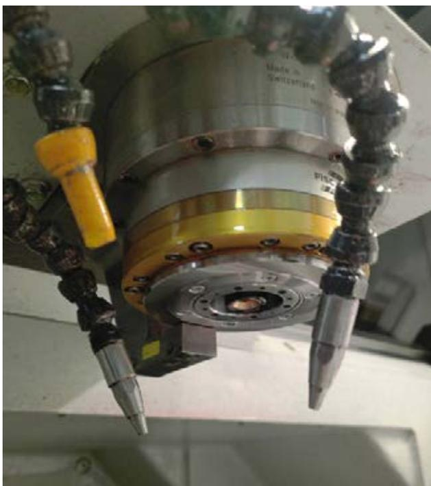
圖 1：控制主軸伸長量
