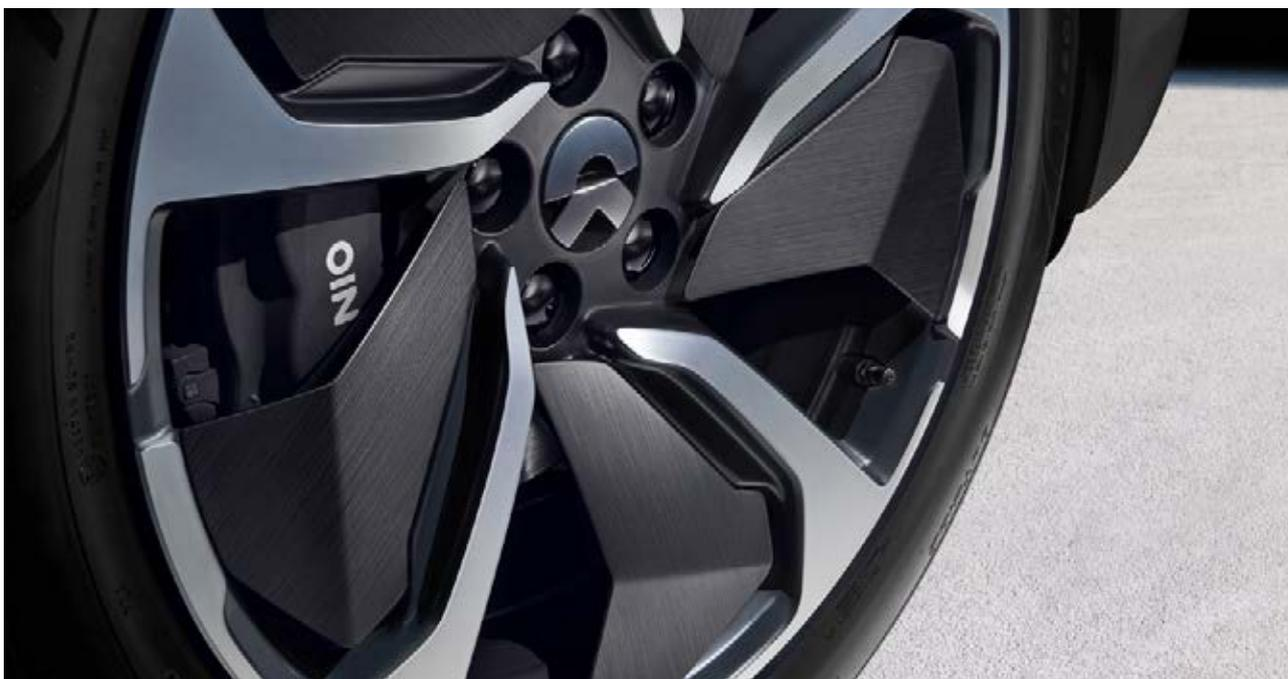
擊性，耐化學性和耐候性。Maezio™所基於的模克隆®聚碳酸酯具有很高的熱穩定性，因此輪葉插件可以承受高達 150°C 的製動引起的溫度。
