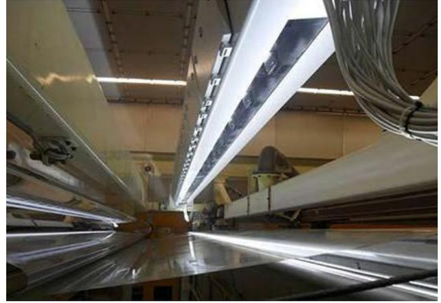
圖 2：獨立頻閃 LED 技術可以檢測薄膜是否存在缺陷及監控其光學特性
