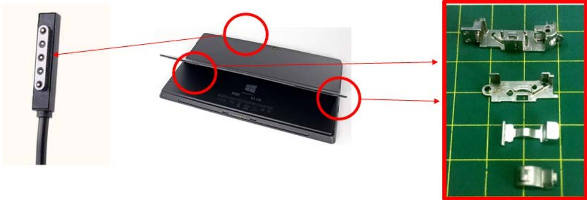
圖 1.10：在微軟平板 Surface 所看到的到支 MIM 零件，用量和設計都是充分利用 MIM 的特性
