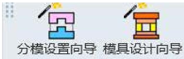
這樣的拆分對全 3D 模具設計用戶而言，可以將整個工作化繁為簡，將 3D 拆模和模具結構設計分工完成，互不影響，從而節約設計總時間。對於非全 3D 設計用戶而言，使用分模設置嚮導即可完成產品分模的工作，其餘工作可以在 2D 軟件中完成，這樣可節省軟件的採購成本。Cimatron 為全 3D 設計用戶提供一套完整的型腔模設計工作流程。按照軟件“型腔模設計”嚮導工具列的指令順序，可方便地完成型腔模設計中的各個環節，對於新員工起到很好的引導作用。下面我們就對這些主要流程指令逐一作簡單介紹。
