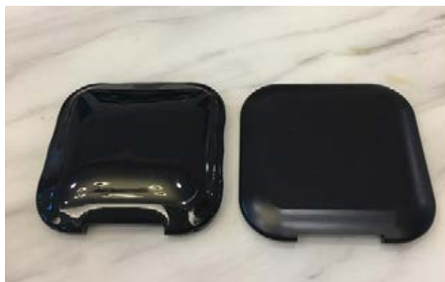
圖 3：圖中的右側樣品為高光處理前的塑膠基材，左側則為高光處理後的成品
