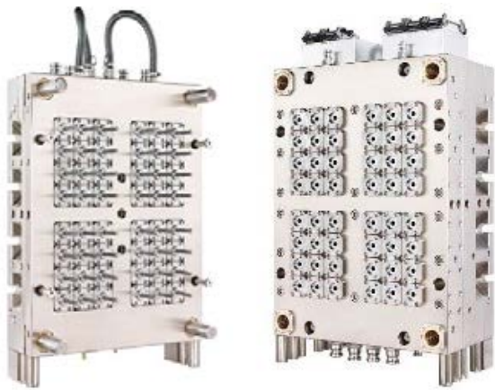
圖 2：用於生產採血管的模具及最終成品，該產品由醫療版 EcoPower Xpress 160 射出機生產
