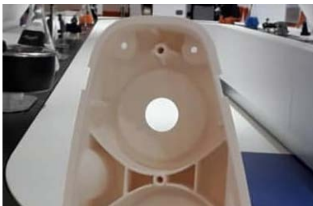
圖 3：帝斯曼 (DSM) 展位展示 3D 列印機車備品零件
