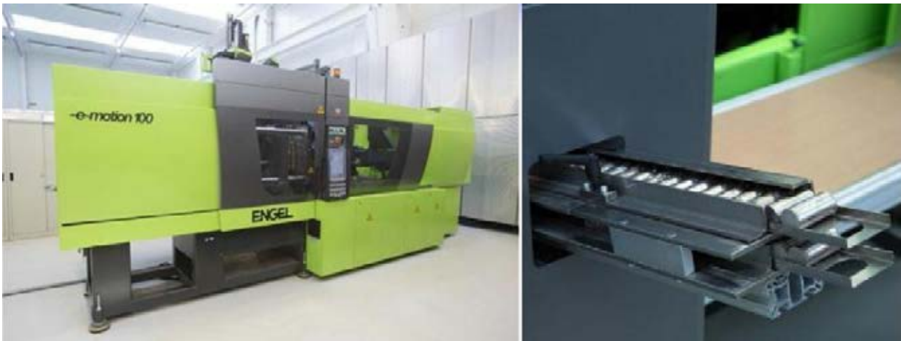
圖 5：左圖，最先進的 LQMT 壓鑄機與傳統塑料射出成型機外型類似，主要差異在於真空熔體腔 / 熔湯槽；LQMT 的定量注射要熔掉的一整個材料錠形狀
