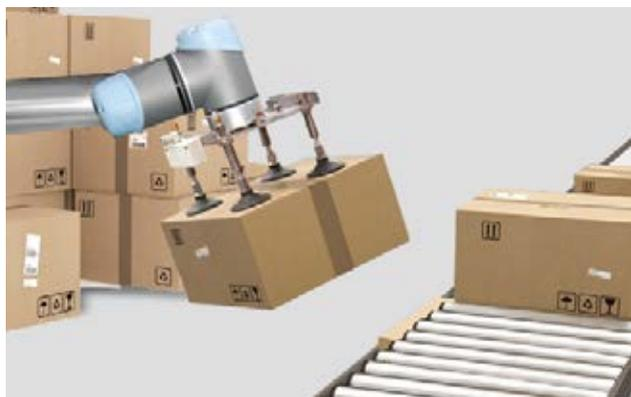
圖 1：AccuPick 智能取放系統
