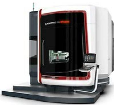
圖 1：在五軸激光沉積焊接領域，DMG MORI 在 formnext 展會上展示其新型 LASERTEC 125 3D hybrid。該機床專為最大  $\varnothing 1,250 \times 745$  mm 和 2,000 kg 的工件而設計
