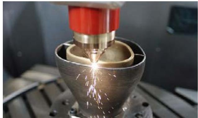
圖 2：DMG MORI 的 LASERTEC 3D/3D hybrid 系列機器也可以實現多材料應用和漸變材料
