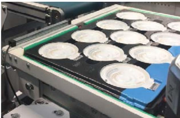
圖 5：在 Arburg 展位上展示 TactoTek 射出結構電子 (IMSE™) 產品——小夜燈的連續生產與組裝製程
