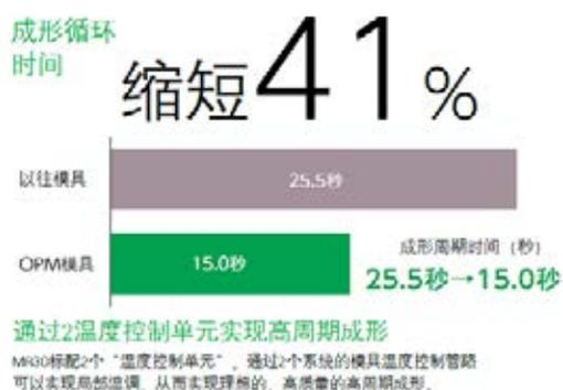
圖 10 : OPM 模具的成形冷卻效果 / 圖 11 : OPM 模具的成形週期效果
