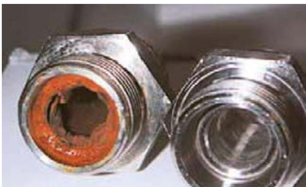
圖 6：通過清潔和維護溫度控制通道來提高產品生產率
