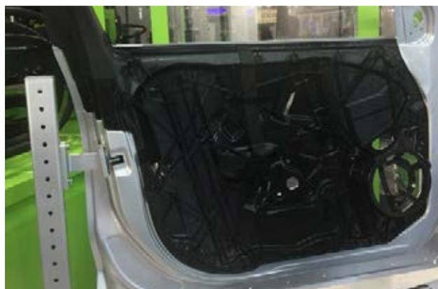
圖 12 : Engel 展位展出纖維預浸材補強複合材料應用於汽車產品的射出成型整合生產製程
