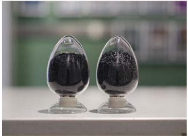
圖 2：金暘碳纖維增強 PA 除為產品提高強度與減輕重量外，同時還具有優良的耐疲勞和阻尼減震效果
