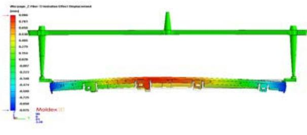
圖 6：原始設計的變形趨勢與量值 (形成往下哭臉的樣子)
