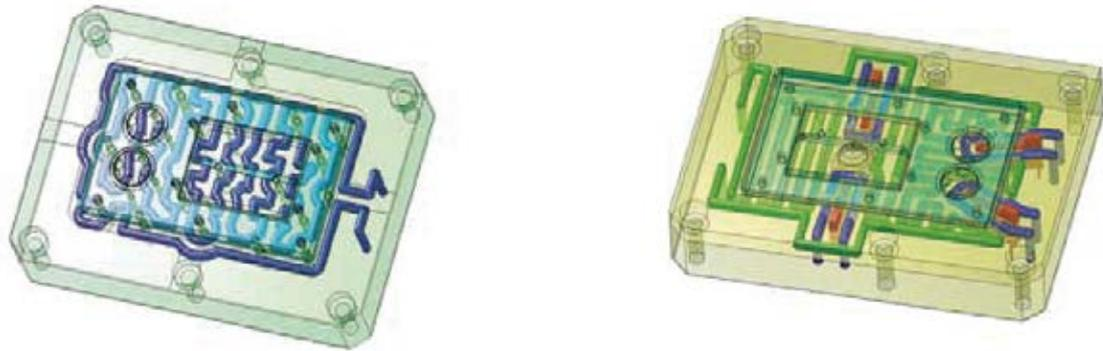
圖 4：通過在型腔正下方安裝高密度陶瓷加熱器來避免可見熔接線
