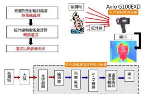
圖 2：熱像測溫儀可以快速檢測各項產品設備的操作狀態，及早發現產品設備過熱，並解決溫度問題
