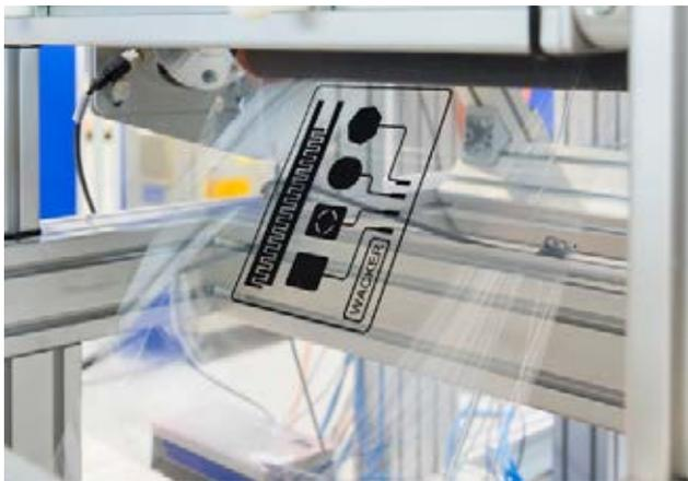
圖 3：由多層塗有導電材料的超薄有機矽精密薄膜組成，可用作運動執行器或測量機械形變的感測器
