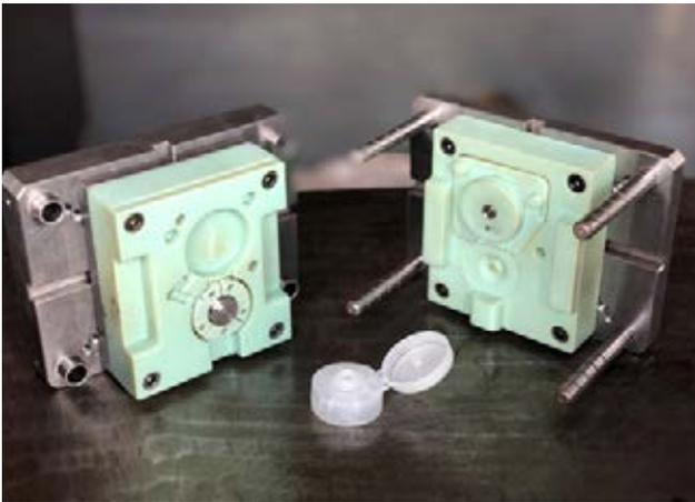
圖 1：綠色部份為透過 PolyJet 3D 列印技術快速列印而成的耐高溫塑膠模仁
