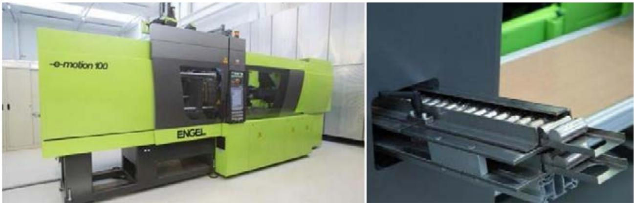
圖 4：左圖：最先進的 LQMT 壓鑄機與傳統塑料射出成型機外型類似，主要差異在於真空熔體腔（熔湯槽）；圖右：LQMT 的定量注射要熔掉的一整個材料錠形狀
