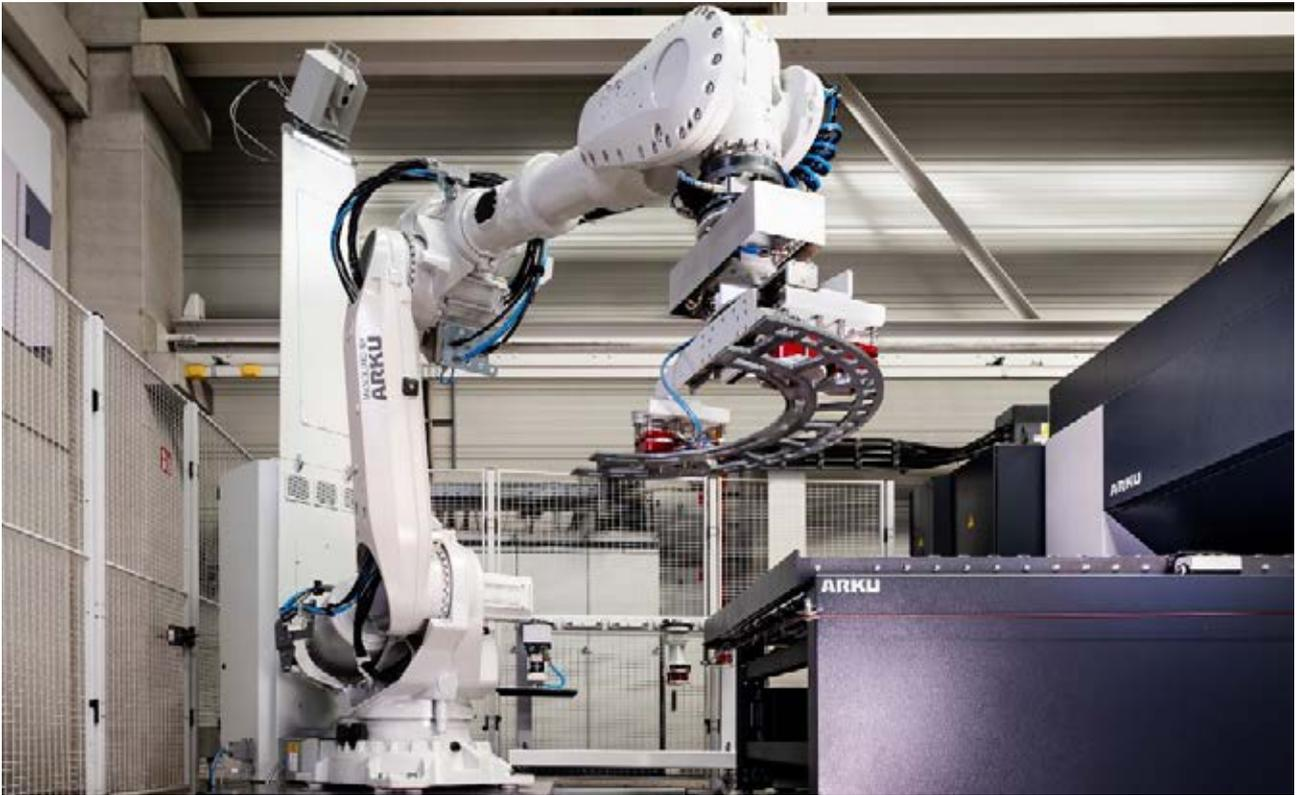
圖 1：能抓取、會觀察的阿庫視覺機器人加速了矯平去毛刺設備的上下料流程
