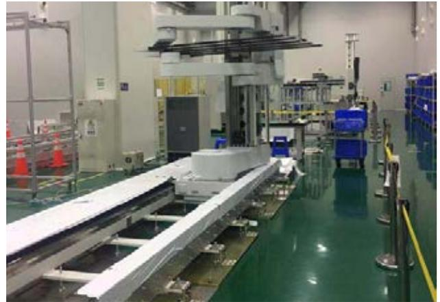
圖 2：透過創新的優化設計、高速振動抑制技術與專用材質的開發，使機器人得以順利搬運纖薄的 OLED 器件
