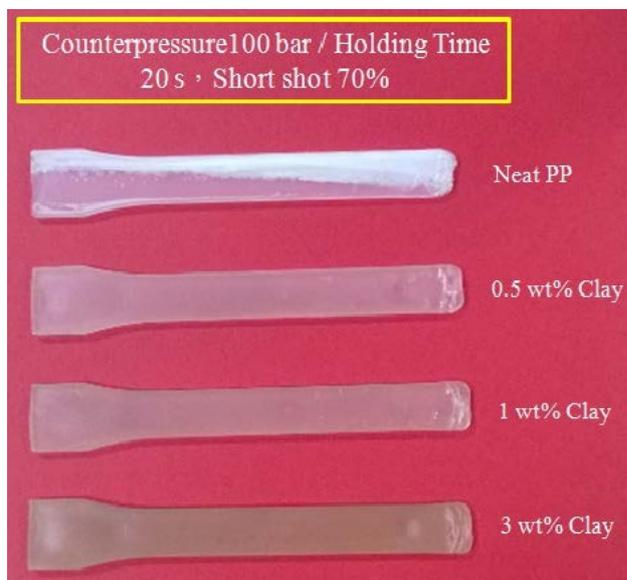
圖 4：從加入奈米蒙脫土有助於提升材料阻氣性，圖中可觀測到，加入蒙脫土後，便沒有氣泡進入產品的情形發生
