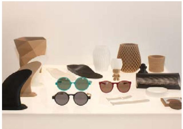
圖 4：圖為透過 PAM 顆粒印表機產出的成品，該機器除可生產樣品外，也適用於生產功能性原型
