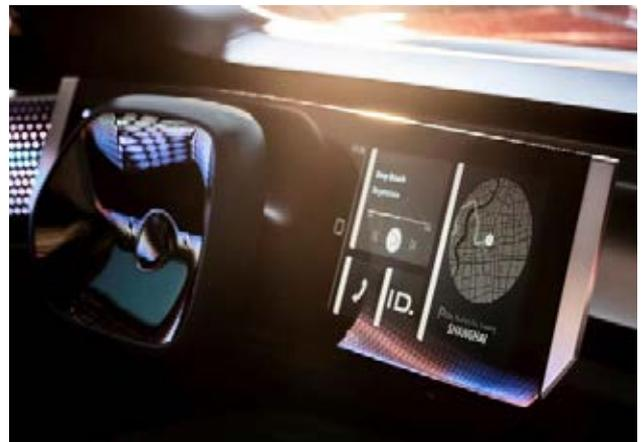
圖 2：帶有數位化控制元件的方向盤被集成在一個大型「數位化座艙」中，取代了傳統的儀表板
