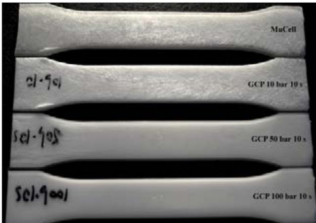
圖 1：反壓低於 50 Bar 時，產品表面會呈現粗糙不光滑；反之，若高於 50 Bar，則產品表面顯得極為光滑
