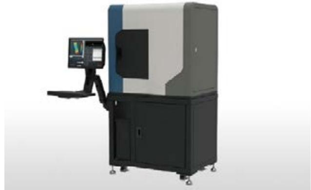
**圖 4：光學非接觸式表面 3D 輪廓量測儀**
