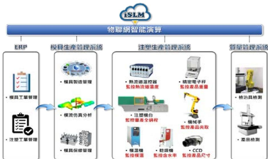
圖 2：物聯網集成模具、射出與質量管理系統
