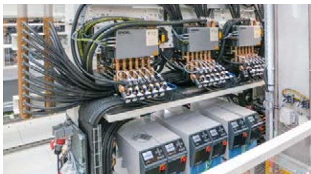
圖 2：緊湊集成：生產單元在機器側面和背面裝備 e-floMos 和溫度控制單元
