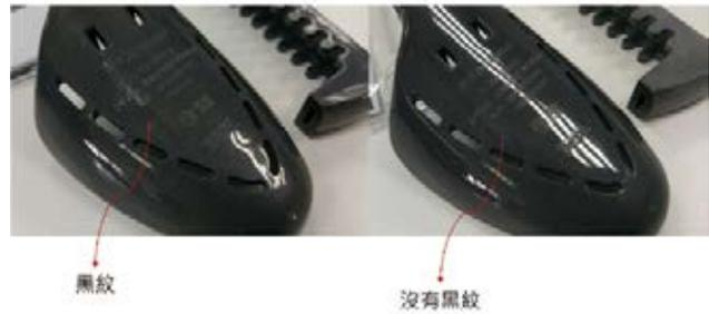
圖 2：透過百豐科技變模溫控制技術，在適當的溫度及壓力下，塑件表面會形成抗刮的硬化層，解決金屬粉末質感添加劑有結合線及黑紋的問題
