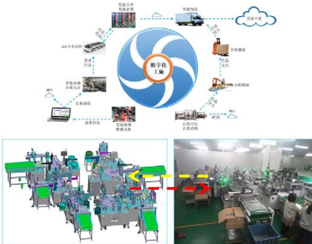
圖 3：上圖為數字化工廠信息與物聯網之關聯圖，而下圖則是透過建立數據驅動的虛擬智能工廠（信息系統）與物理工廠相互映射
