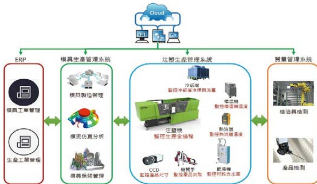
圖 3：射出 4.0 智慧工廠運營系統之布局
