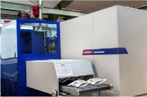
圖 1：採用配有集成生產單元的 SmartPower 300/1330 射出機生產飲水機的外殼部件（圖片來自威猛巴頓菲爾）
