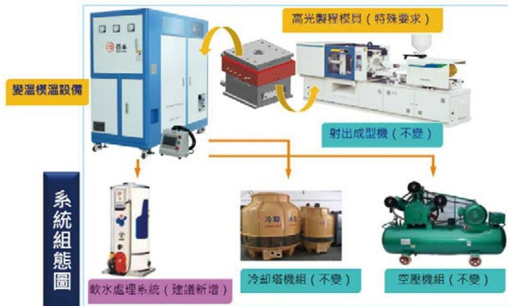
圖 6：變模溫控制設備及整體解決方案
