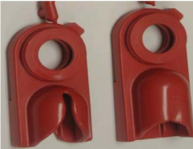
圖 3：圖為現場實際開模射出的短射物品案例，幾何對稱，但是射出後卻有明顯差異，如流道長短腳、相同模穴卻體積不同，或對稱左右面積有差異
