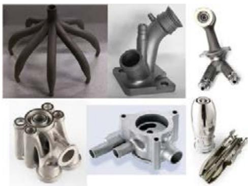
圖 7：岐管積層製造應用案例（工研院彙整）
