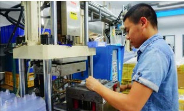
圖 5：雙色鏡框技術：員工將環保新素材 TPR 以植入式射出包覆技術，將軟料直接成型融合於鏡片上
