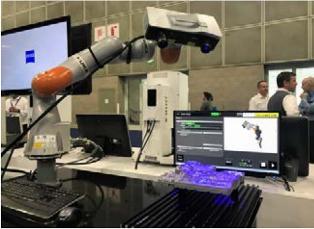
圖 2：搭配 KUKA 機械手臂，使掃描流程更加快速流暢
