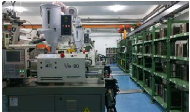
圖 6：模具陳列架：要求模具定位，搭配電動模具吊架，提高安全性
