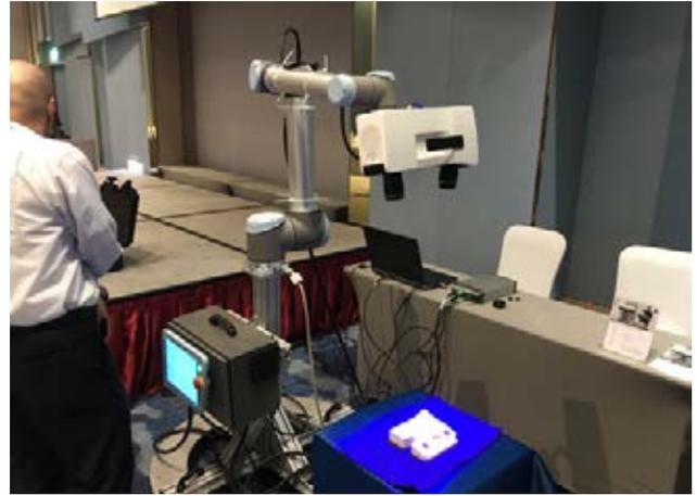
圖 3：搭配 Universal Robots 協作型機器手臂，掃描作業也能自動化運行
