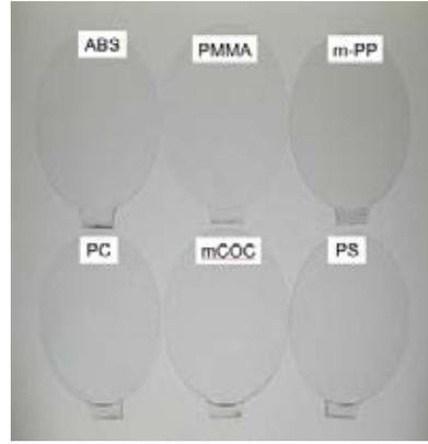
圖 8：以肉眼觀測不同透明塑膠材料試片之結果
