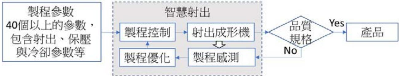
圖 2：智能射出過程的示意圖
