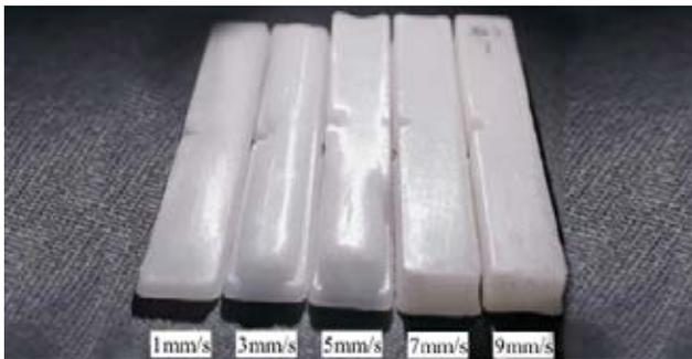
圖 1：不同的模仁後退率產生的試片厚度 [1]
