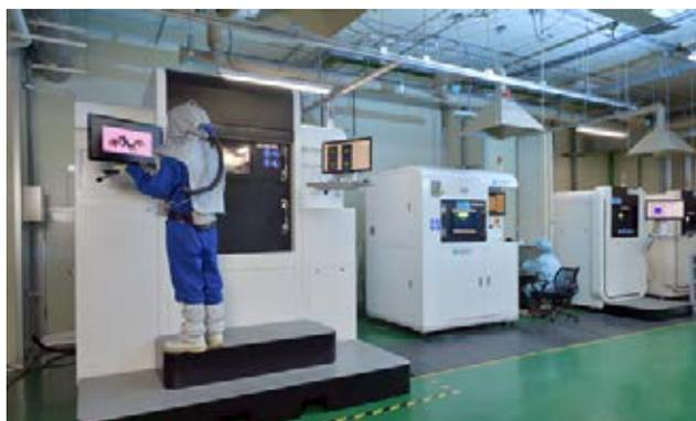
圖 5：工研院金屬積層製造自主設備（工研院資料）
