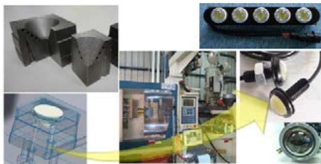
圖 6：LED 燈殼模具應用案例（工研院彙整）
