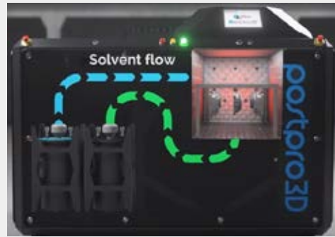
圖 4：PostPro3D 作動示意圖 [5]
