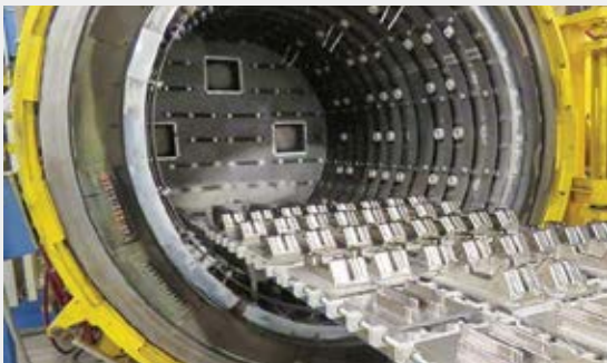
圖 13：將零件置於真空爐中熱處理 [11]
