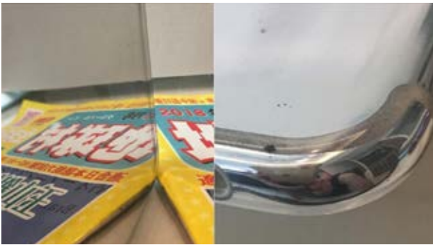
圖 3：除可以如鏡面般反射出雜誌封面影像外，還可在 3D 曲面開口基材上轉折平滑無皺褶
