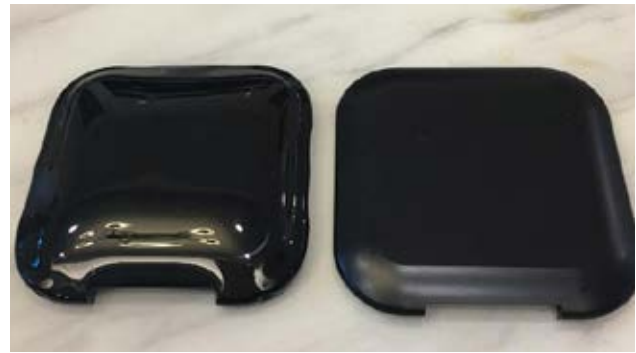
圖 4：ABS 材質化妝盒，轉印前後的對照
