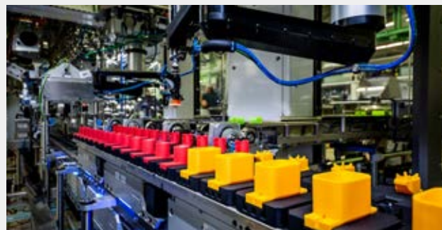
圖 2：3D 列印工具讓一款設備能同時處理不同產品
