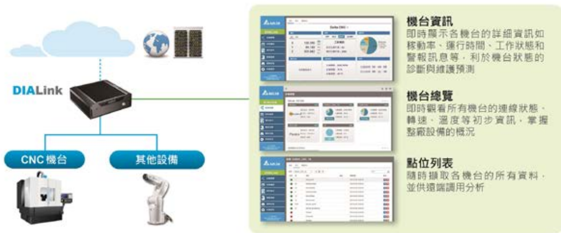
圖 3：彙整機臺資訊，經由統一平臺連結雲端，輕易建構機聯網
