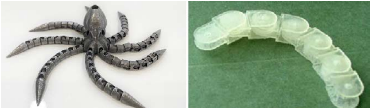
圖 3：左為金屬 3D 打印的章魚模型產品，每隻爪都能獨立活動甚至每個爪上的關節也能活動；右為以聚合物採 UV 光固化保留動件之間適當零件間隙可以直接印出，每個關節都可以有限度地轉動和運動
