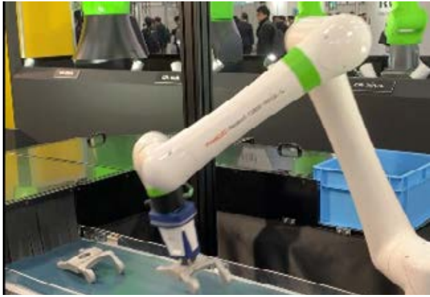
圖 1：FANUC 使用眼到手 (Eye-to-Hand) 相機並結合流水線作金屬工件夾取 (iRex 2019)
