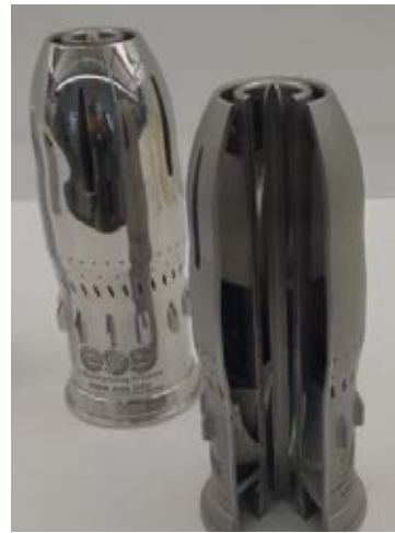
圖 2：在德國 EOS 總部展示廳由 Dr. Q 親自拍攝，以 3D 打印 SLS 製作並用於法國空中客車的噴射機渦輪燃油噴嘴
