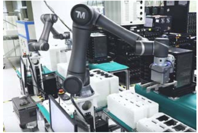
圖 2：達明以眼在手 (Eye-in-Hand) 相機定位 3C 產品零件
