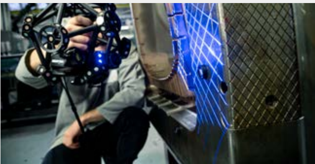
圖 1：新款 MetraSCAN Black 系列 無須消光噴粉及貼點印 可掃描黑色塑件 / 鑄零件模具 / 高光亮面的外觀件
