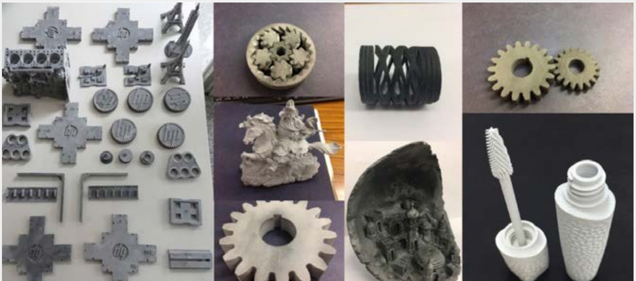
圖 3：惠普 (HP) 多射流熔融高速 3D 列印成品與應用 (圖片來源：臺科大高速 3D 列印研究中心)
