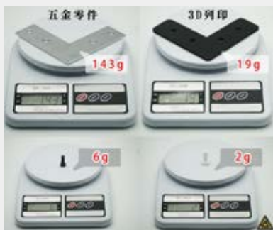
圖 1：透過 3D 列印內部零件達到輕量化
