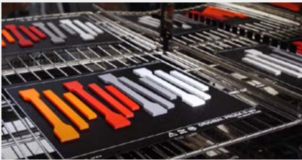
圖 11：將零件置於烘箱中熱處理 [10]
